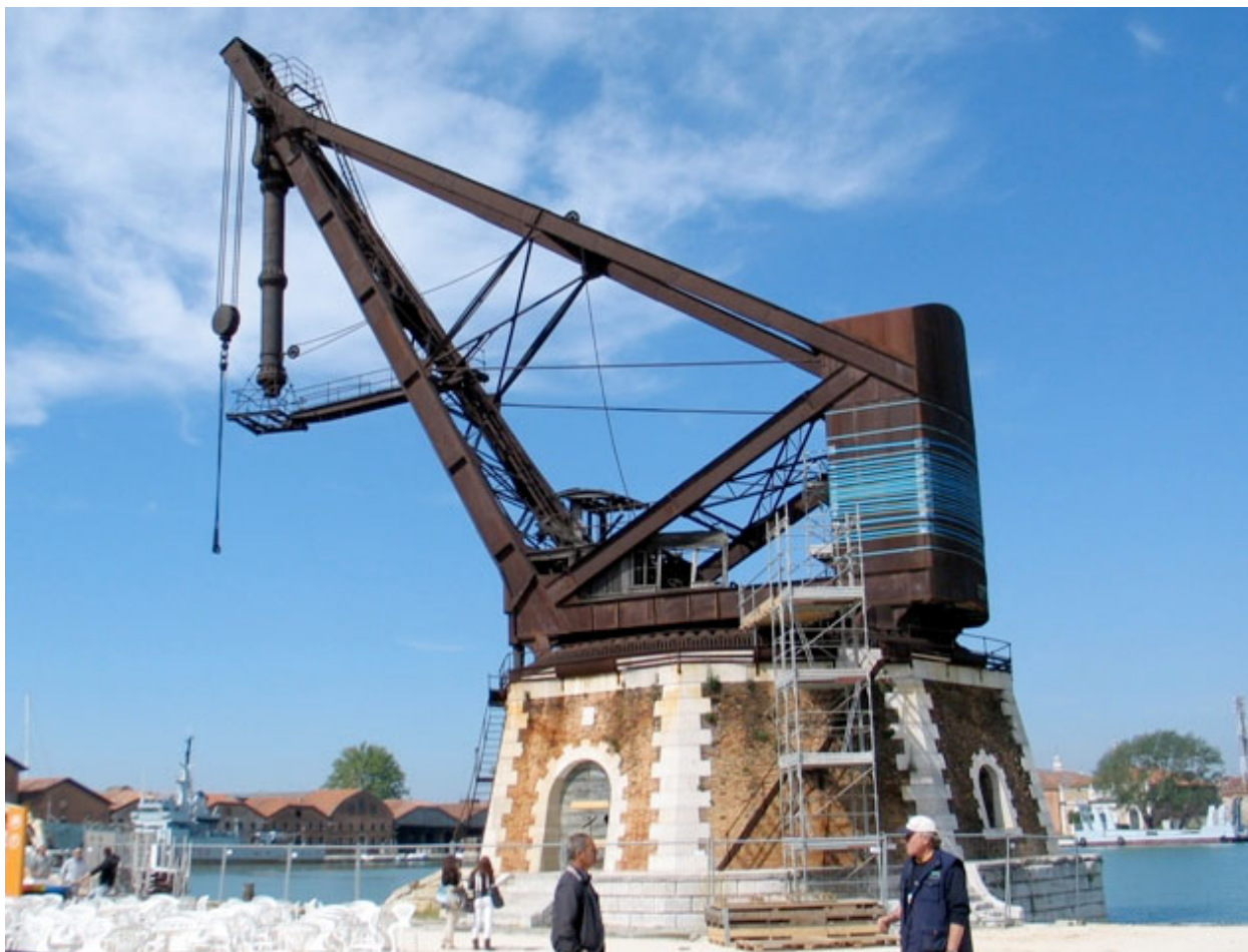
Slika 9 - W. Armstrong hidraulička dizalica [3]
