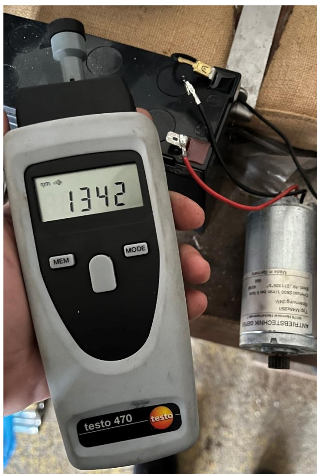
Slika 27: Predodžba ispitivanja brzine motora uz pomoć tahografa. Izvorno autor.
