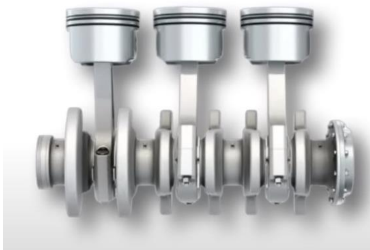
Slika 1. Redni trocilindarski motor [8]
