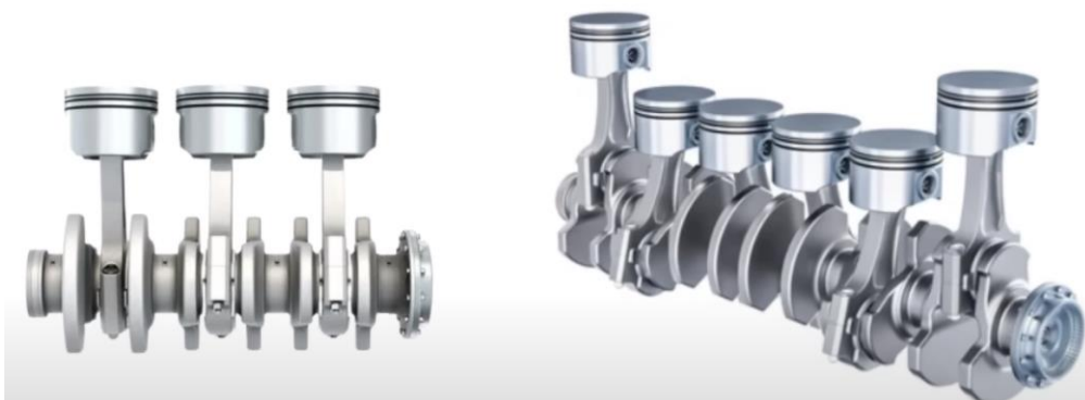
Slika 47. Raspored klipova u trocilindričnom i šestocilindarskom motoru [8]
