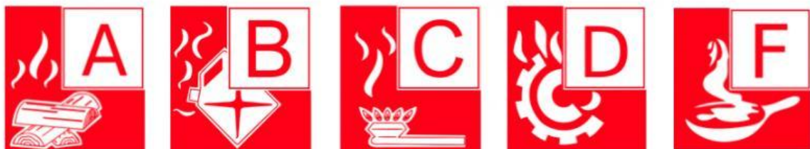
Sl. 3. Klasifikacija požara prema vrsti gorive tvari [7]
