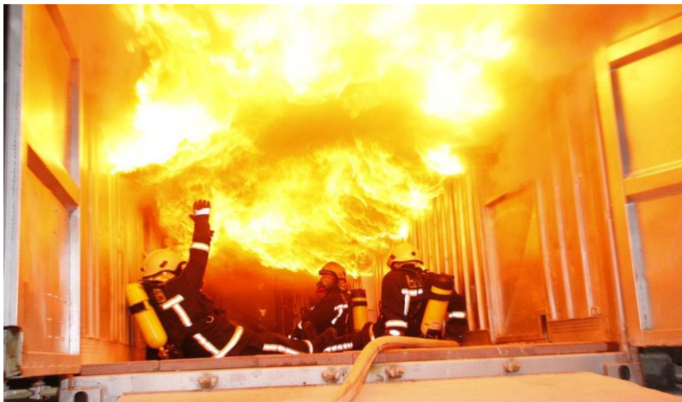
Slika 5.3 Simulator plamenih udara na kruta goriva Izvor: www.dvd-makarska.hr
