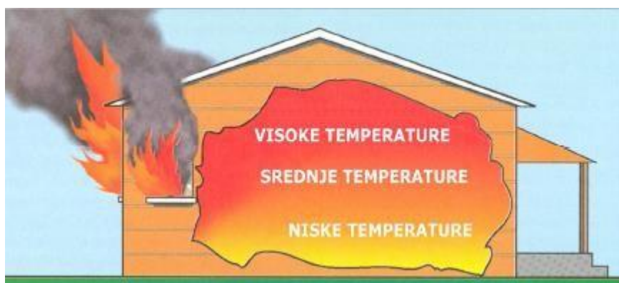
Slika 3.1 Odnos temperature pri požaru zatvorenog prostora Izvor: [3]
