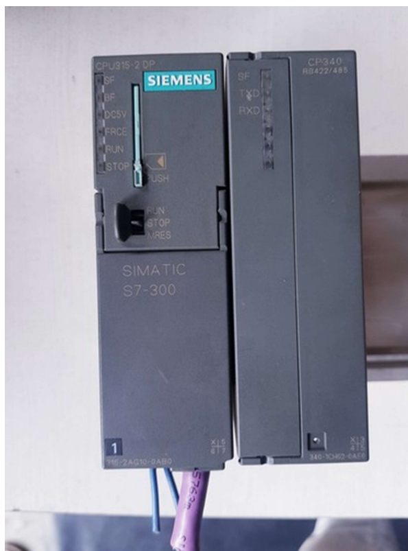
Slika 5. PLC Simatic s7-300 (izvorno autor)
