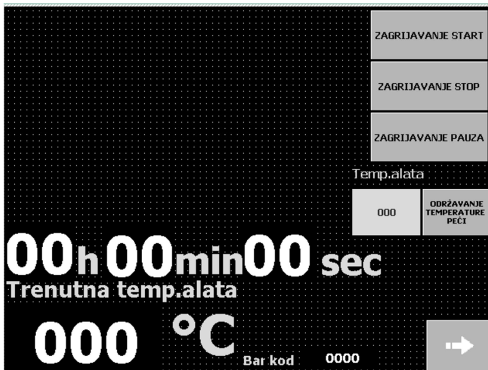
Slika 34. Automatsko upravljanje električne peći (izvorno autor)
