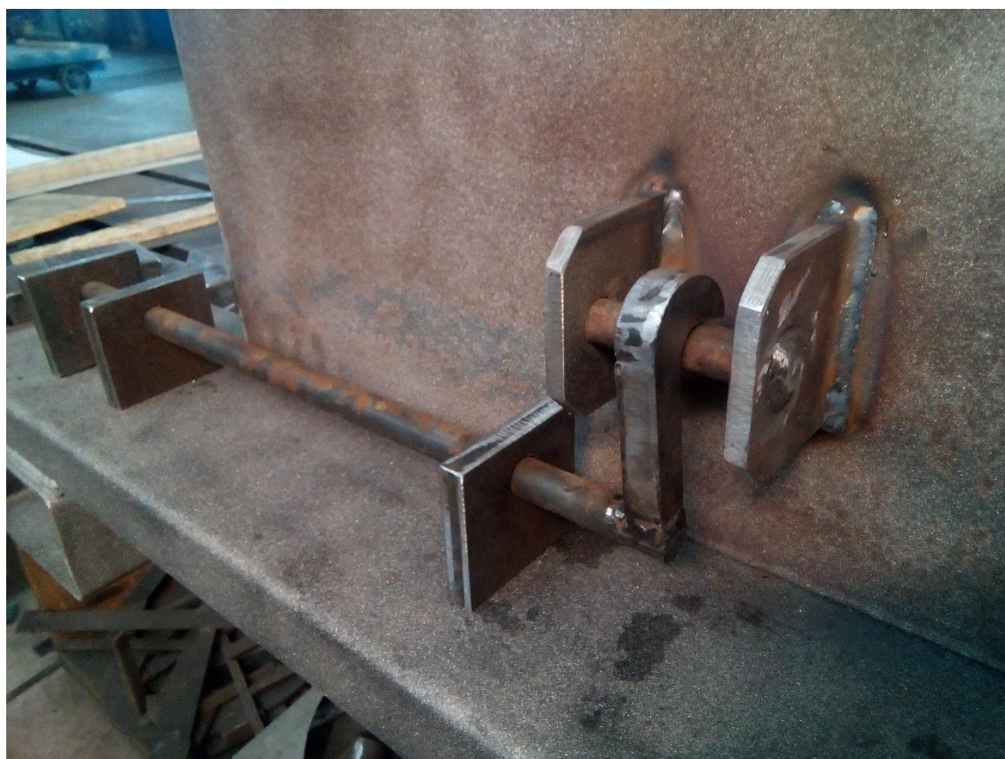
Slika 47. Zavarivanje mehanizma otključavanja, brave i nosača mehanizma
