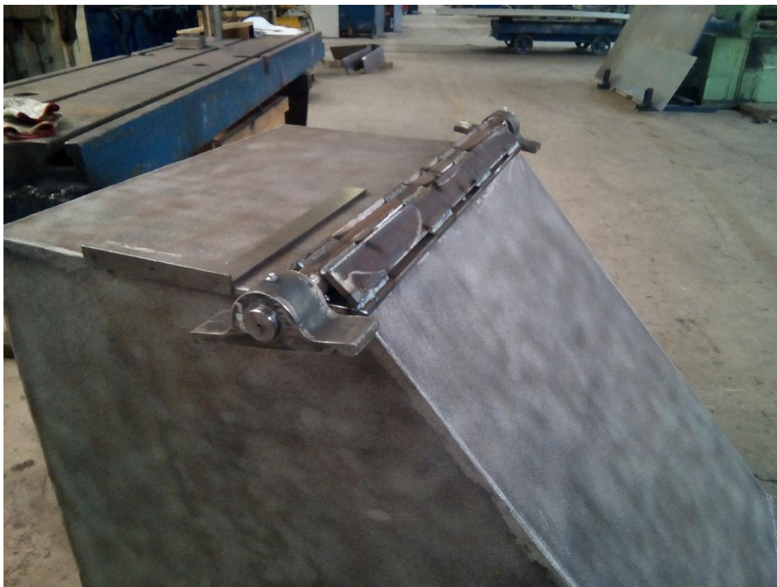
Slika 42. Zavarivanje osovine za donji dio kontejnera
