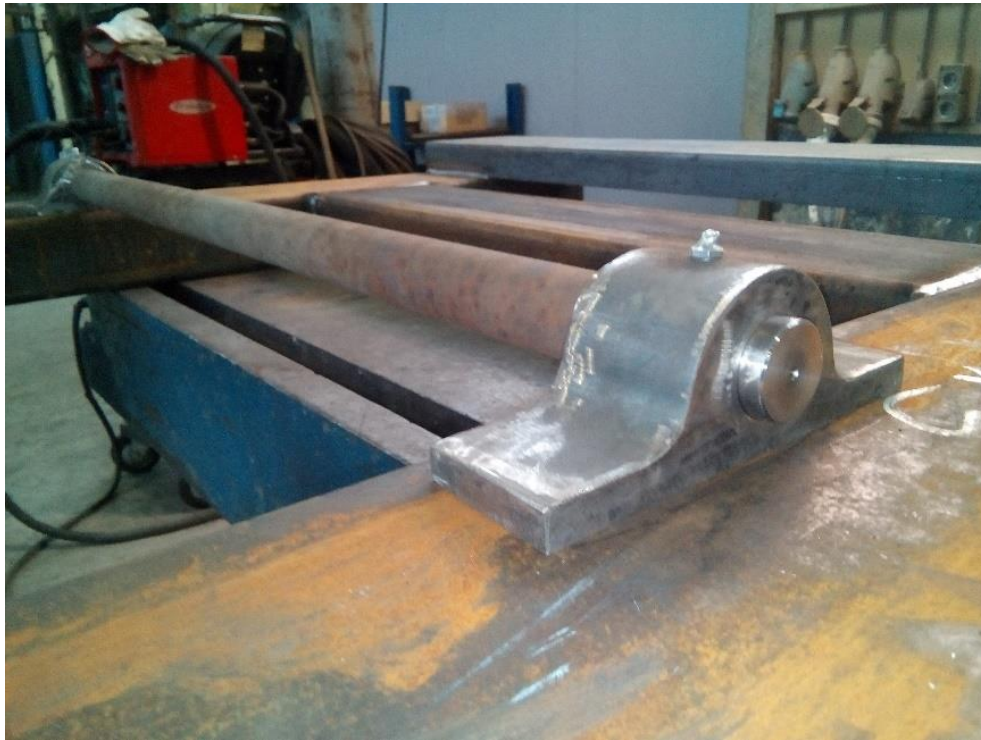
Slika 15. Osovina sa kućištima osovine u procesu proizvodnje (prije operacije zavarivanja za postolje kontejnera)
