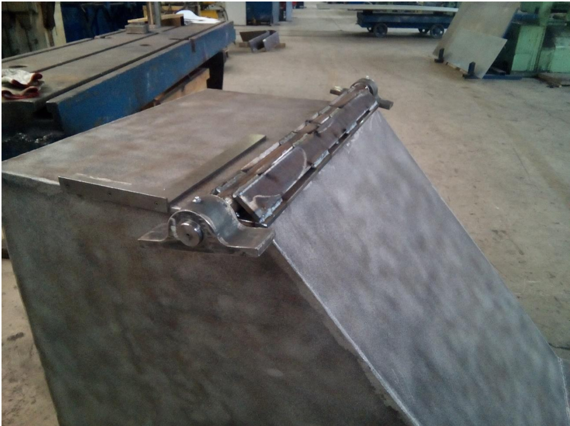
Slika 42. Zavarivanje osovine za donji dio kontejnera
