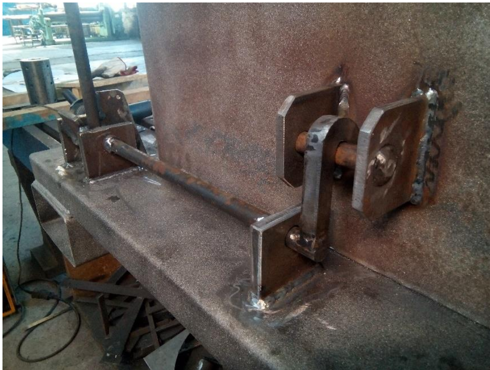
Slika 16. Mehanizam otključavanja kontejnera u procesu proizvodnje
