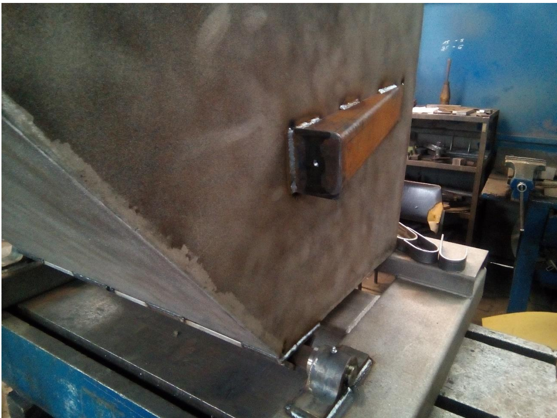
Slika 45. Zavarivanje bočnih odbojnika
