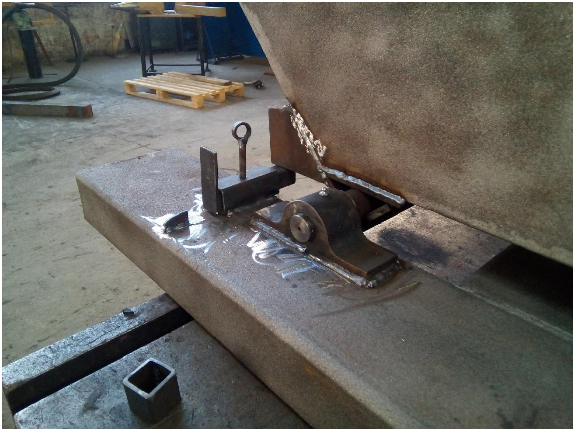
Slika 48. Izrada beta osigurača i zavarivanje njegove vodilice i graničnika na postolje kontejnera
