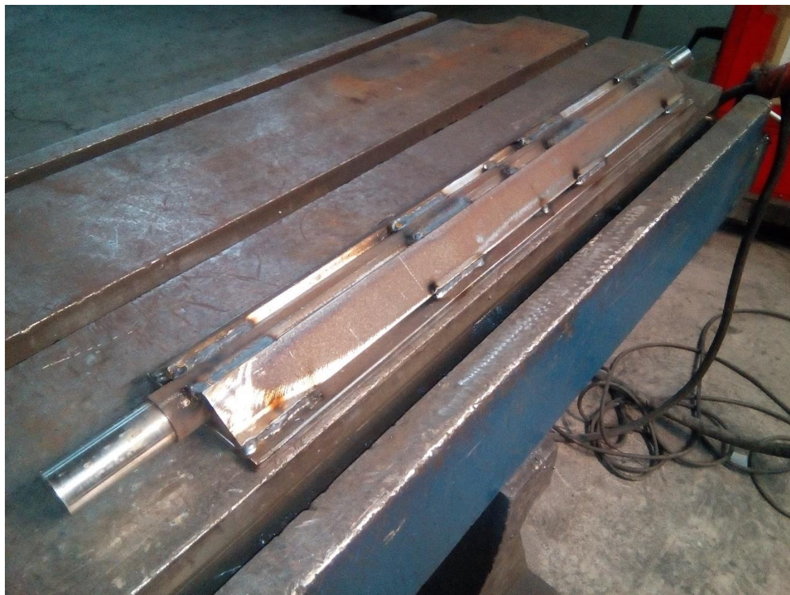
Slika 40. Ojačavanje osovine čeličnim profilima
