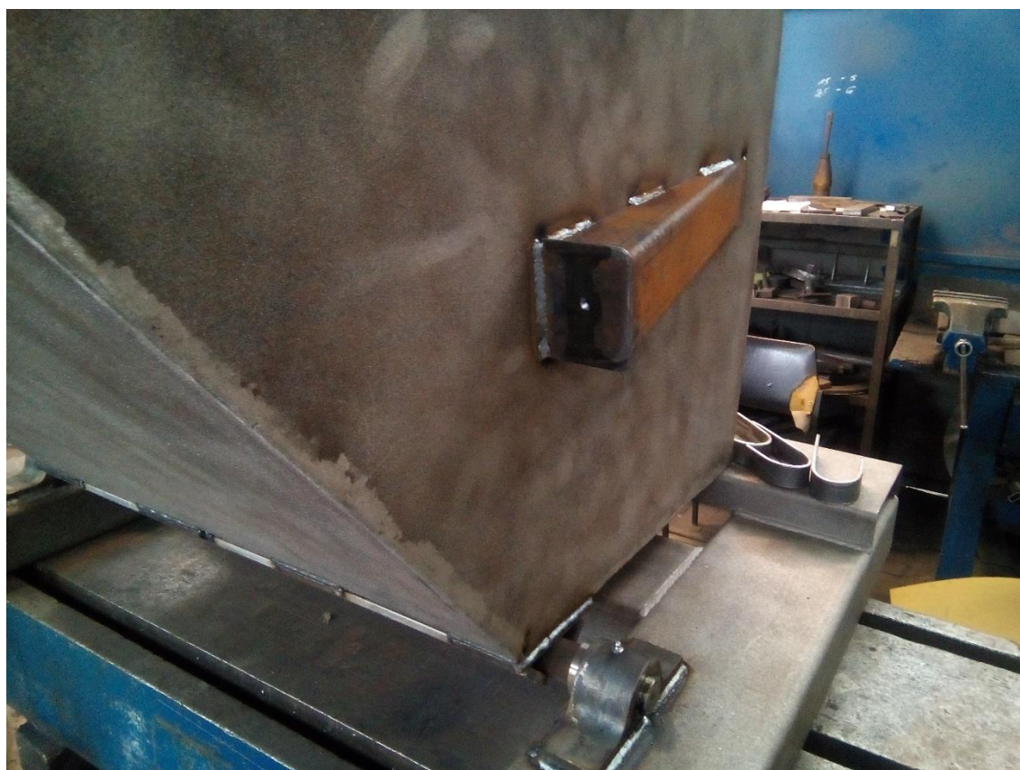
Slika 45. Zavarivanje bočnih odbojnika
