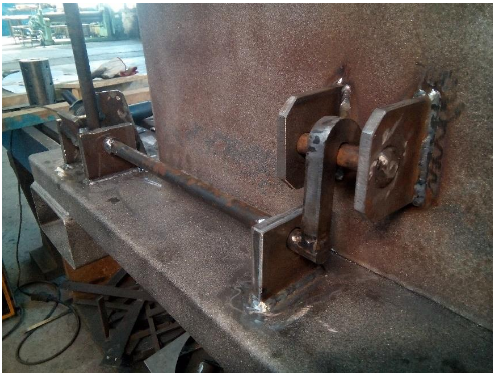
Slika 16. Mehanizam otključavanja kontejnera u procesu proizvodnje
