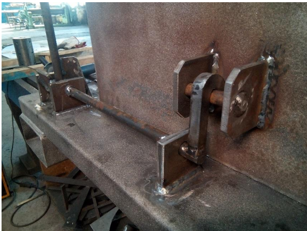
Slika 16. Mehanizam otključavanja kontejnera u procesu proizvodnje
