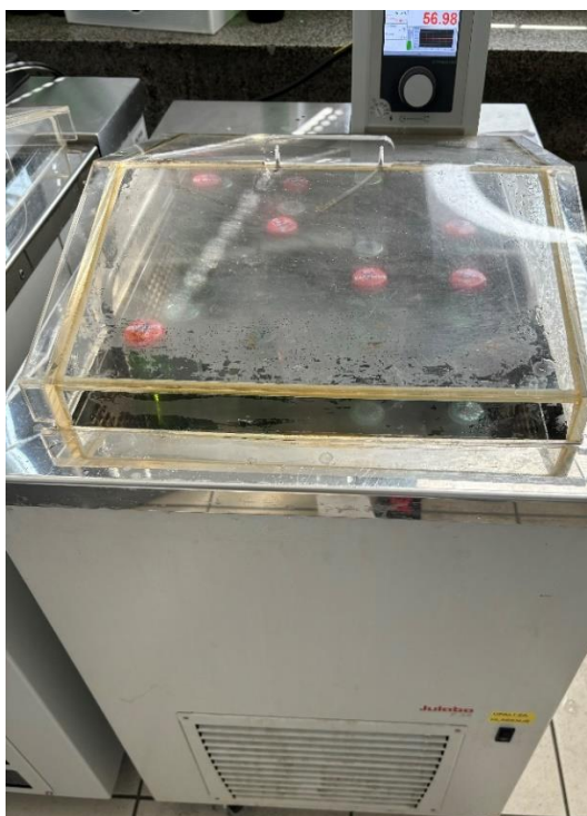
Slika 7. Forsir uređaj za određivanje koloidne stabilnosti piva (autor Ivana Šeketa).
