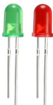
Slika 16. LED diode različitih boja [20]
