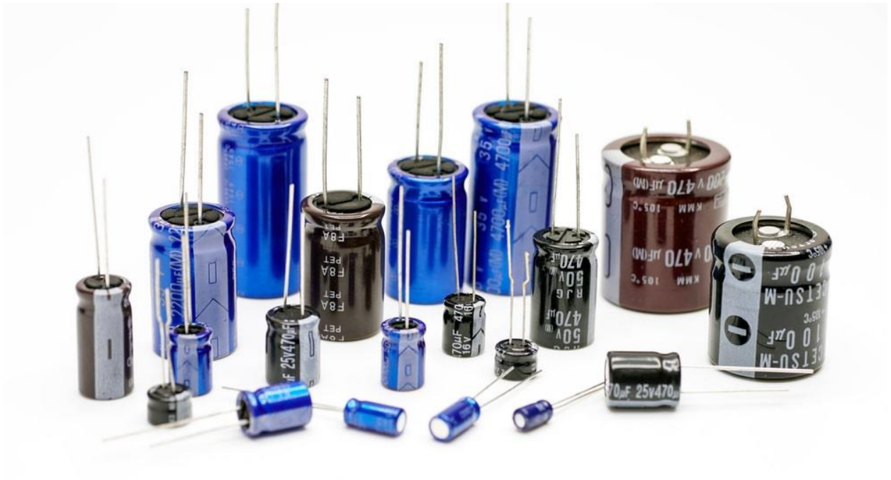
Slika 13. Elektrolitički kondenzatori različitih kapaciteta [14]
