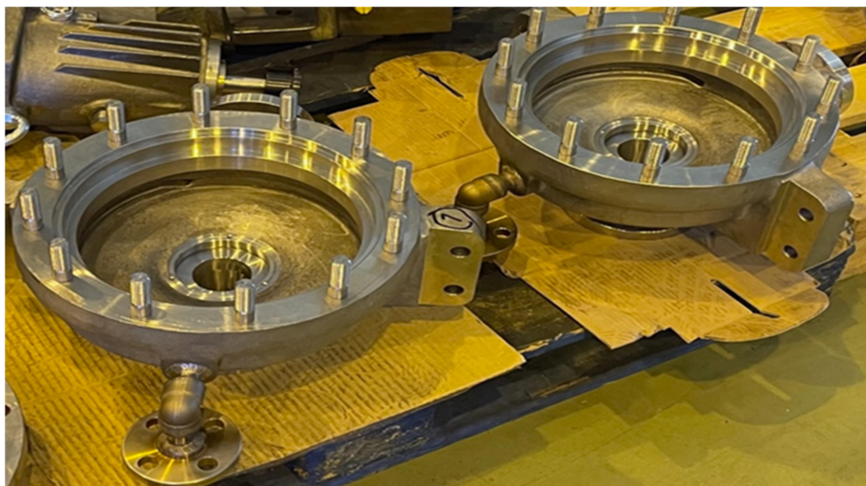
Slika 3 Stator bez lopatica (vlastiti izvor)
