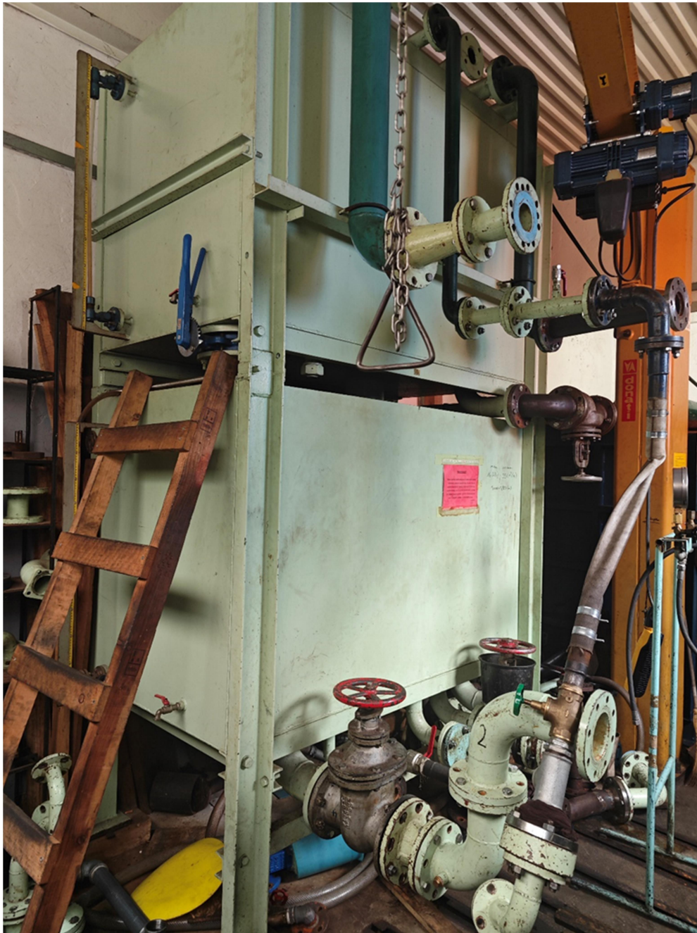
Slika 36 Volumetrička posuda za ispitivanje pumpi [izvor: autor]
