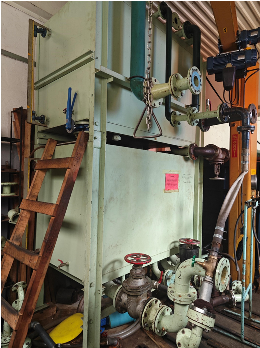
Slika 36 Volumetrička posuda za ispitivanje pumpi [izvor: autor]
