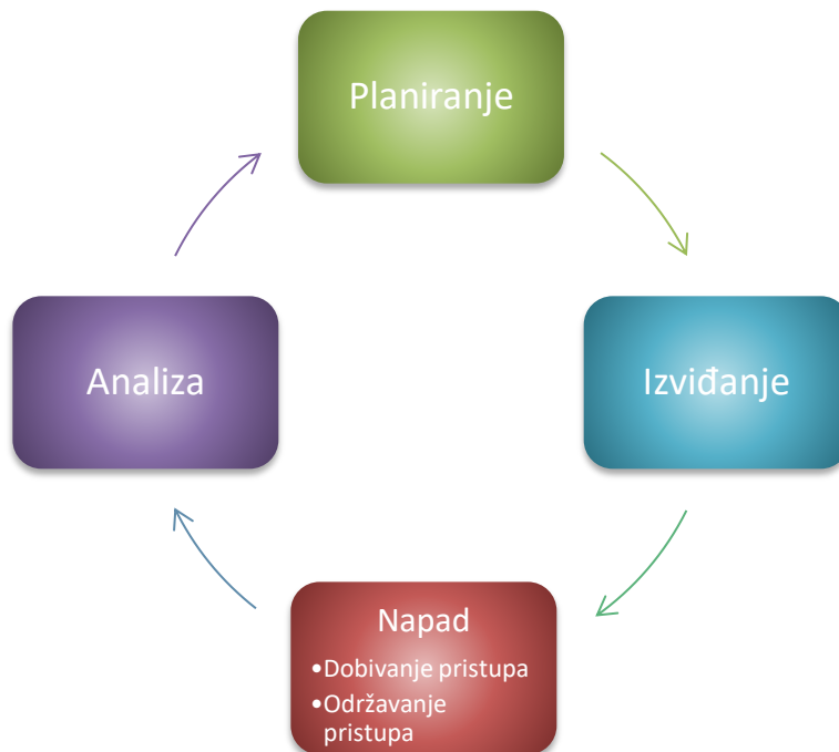
Slika 9 Faze procesa penetracijskog napada, izvor I. Zakarija et al: Primjena odabranog pristupa penetracijskom testiranju računalnih sustava[]
