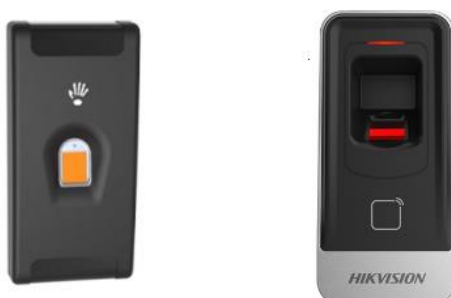
Slika 4.5. Čitač otiska prstiju pri sustavu kontrole pristupa [7]
