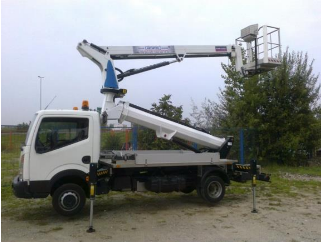
Slika 30: Vozilo s teleskopskom radnom platformom [ https://hematec.hr/proizvod/kamion-s-kosarom-cte-mp20-13/ ]
