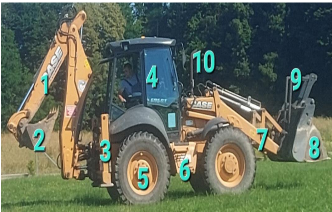
Slika 10. Vanjski dio bagera
