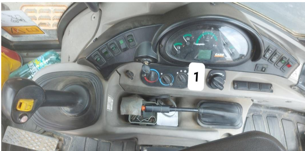
Slika 13. Prekidači za upravljanje prednjom i zadnjom korpom
