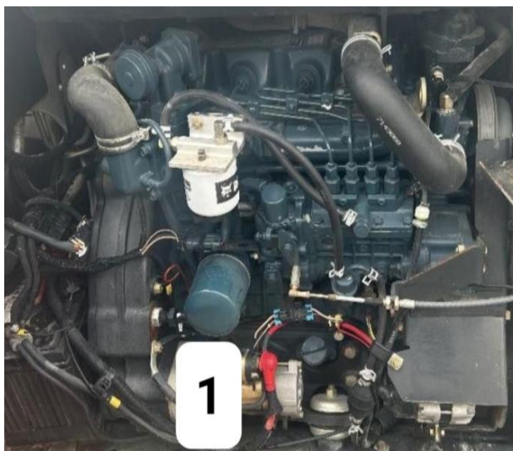
Slika 25. Filter ulja na motoru bagera [15]
