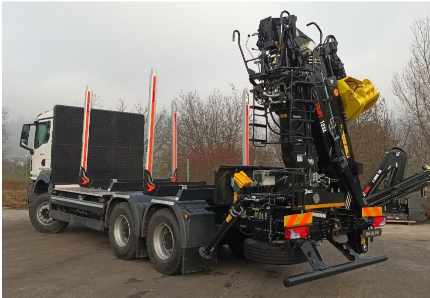
Slika 4. Primjer kamiona sa šumarskom nadogradnjom i dizalicom [3]
