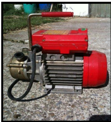
Sl. br. 17 Pumpa za pretakanje vina
