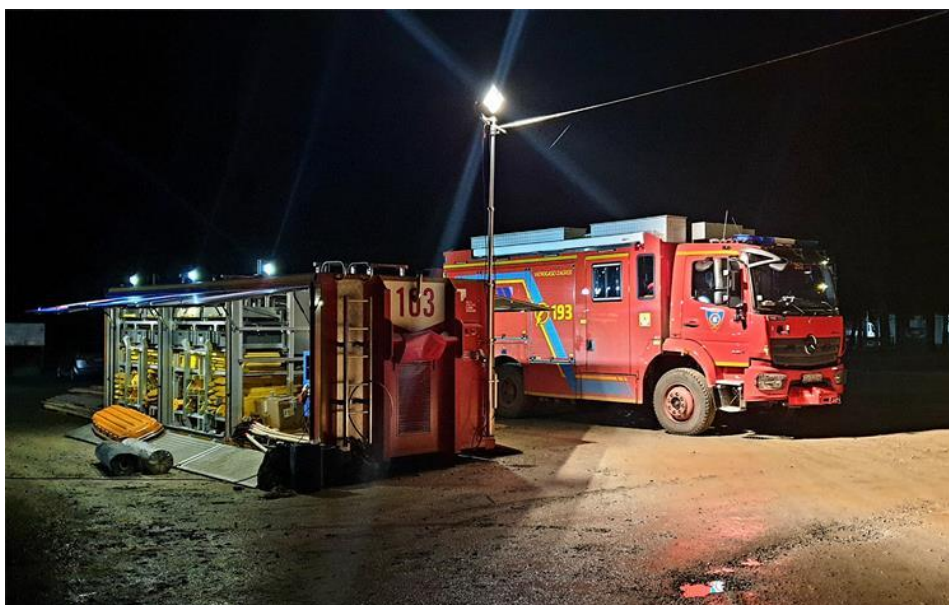
Slika 12. Teško vozilo kontejnerskog tipa [10]
