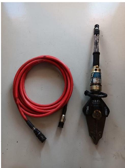
Slika 15. Kombinirani alat sa crijevom [4]
