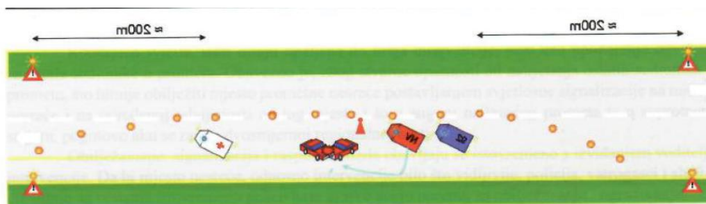
Slika 5. Razmještaj vozila i signalizacije na dvosmjernoj cesti [8]
