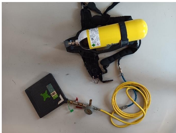
Slika 17. Zračni jastuk spreman za rad [4]
