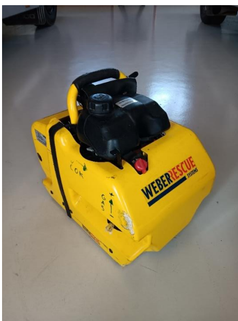
Slika 14. Agregat sa pogonom na benzin [4]
