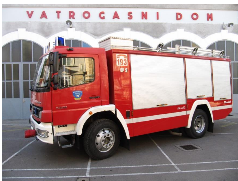
Slika 11. Srednje teško tehničko vozilo (TV-2) [9]
