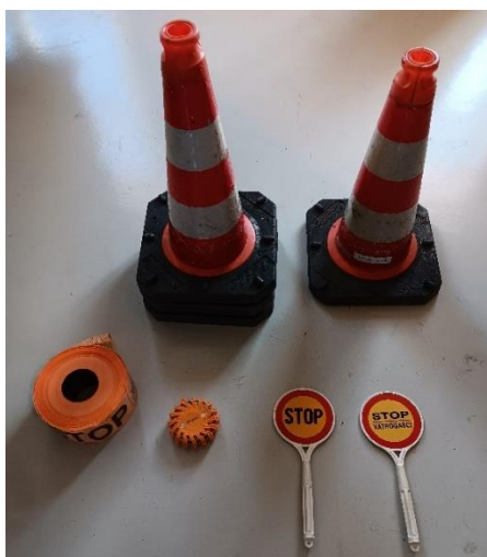
Slika 4. Oprema za obilježavanje i signaliziranje mjesta nesreće [4]
