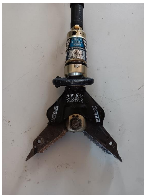
Slika 16. Maksimalni kut čeljusti [4]
