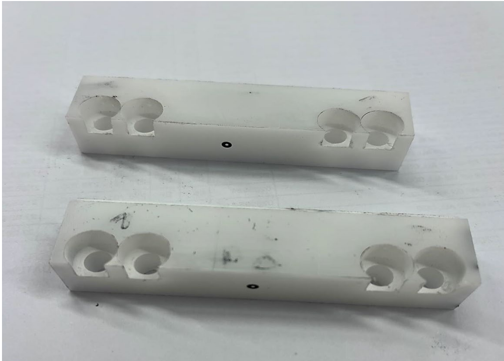
Slika 27 Stezni prihvat od PA-Poliamid
