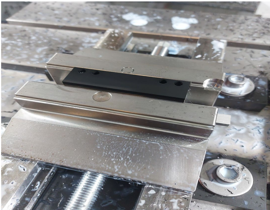
Slika 26 Prikaz steznog prihвата tijekom strojne obrade
