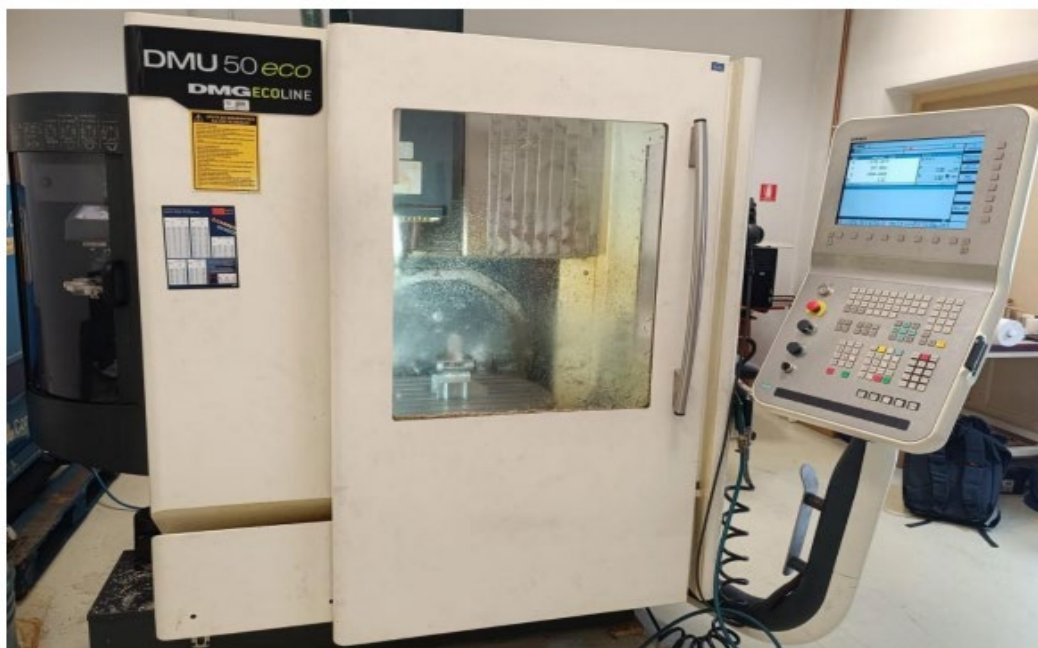
Slika 25 CNC glodalica DMU 50eco
