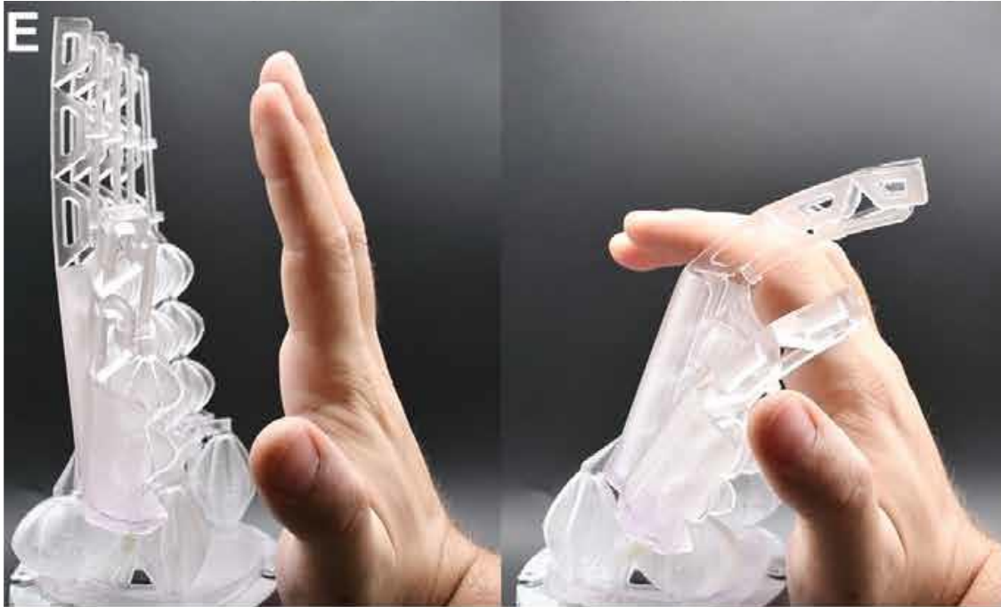
Slika 25. Robotska šaka sastavljena od GRACE-a [9]
