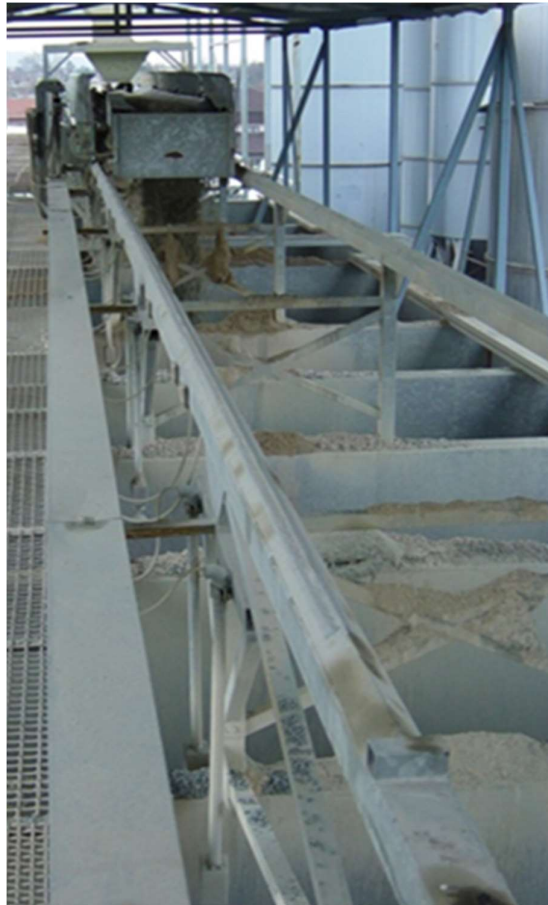
Slika 3. Istovar agregata po boksovima
