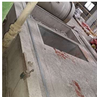
Slika 6. Usipni koševi za agregat i boju na betonari
