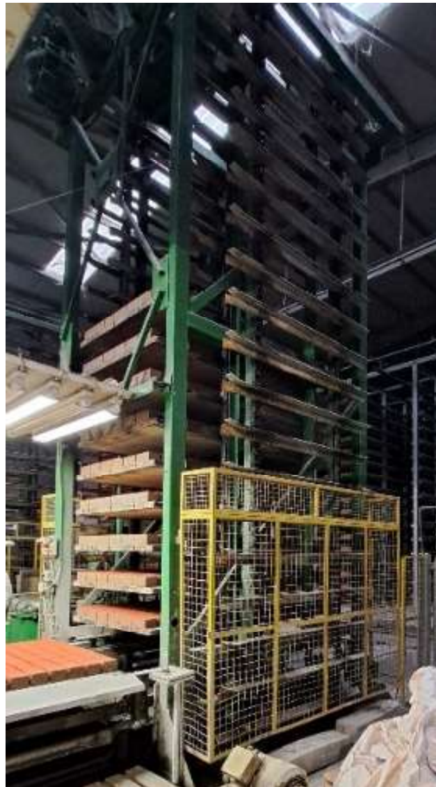
Slika 19. Podizanje betonskih elemenata na transporter za sušaru
