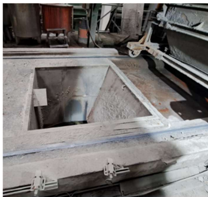
Slika 6. Usipni koševi za agregat i boju na betonari
