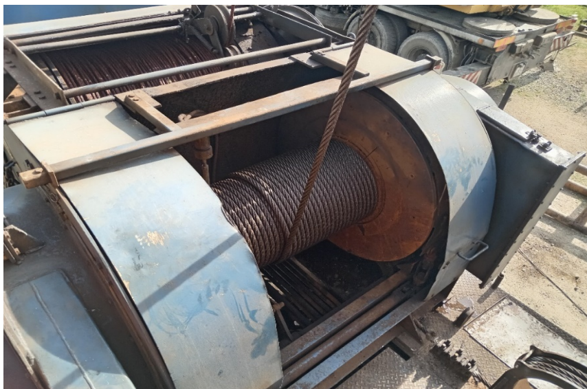
Slika 6. Radni bubanj, radno uže i kočione obloge radnog bubnja [5]
