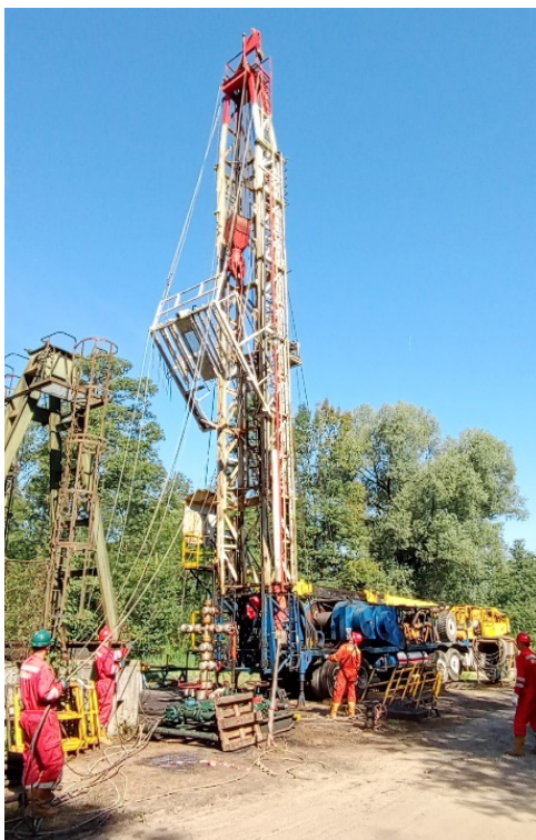
Slika 23. Spuštanje tornja na RP NAT-3 [3]
