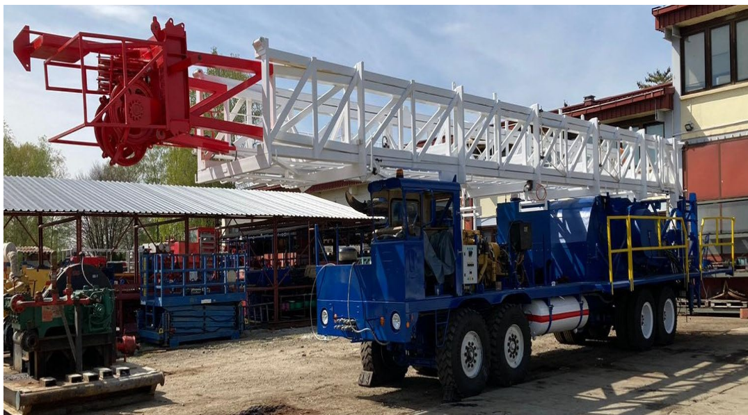
Slika 1. Remontno postrojenje NAT-3 [3]
