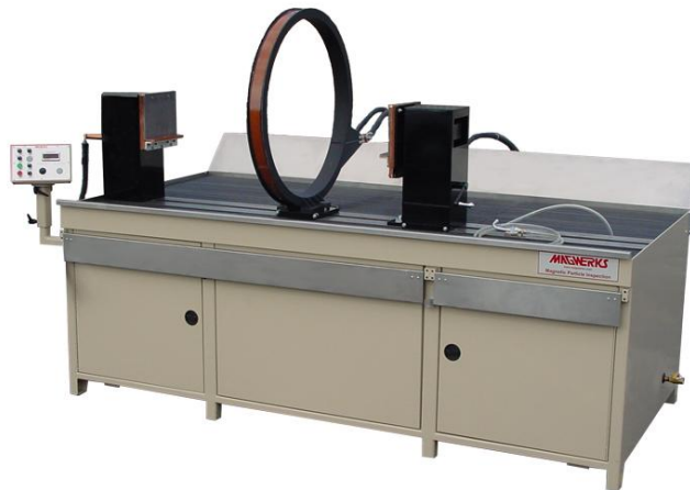
Slika 16: Horizontalna jedinica za mokro ispitivanje
