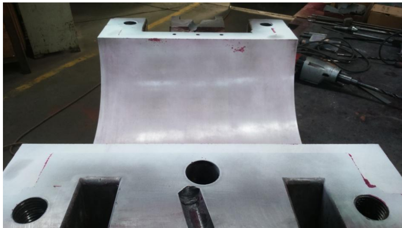
Slika 77a i 77b: Gornja i donja polovica ležaja nakon razvijanja
