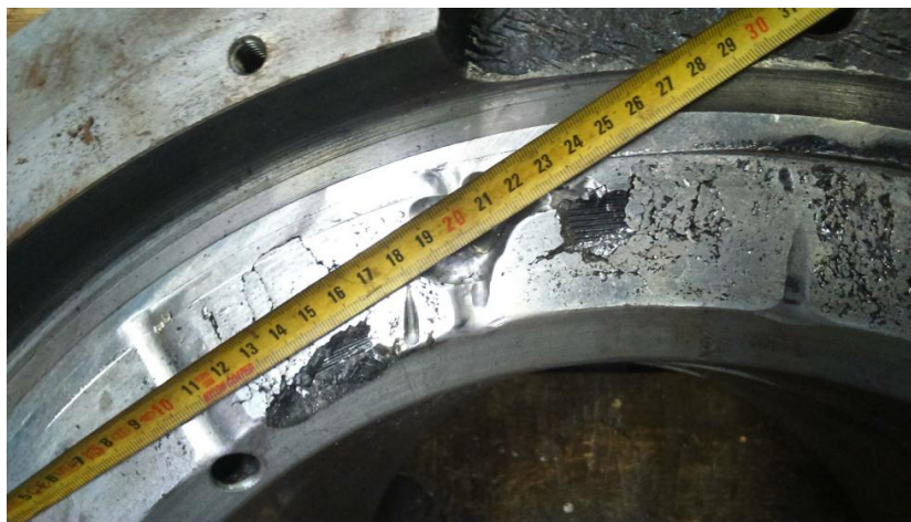
Slika 61a i 61b: Stanje ležaja prije reparacije
