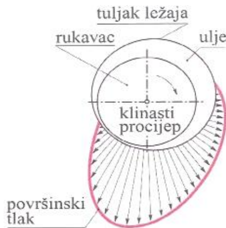
Slika 55: Razdioba površinskog tlaka na blazinicu
