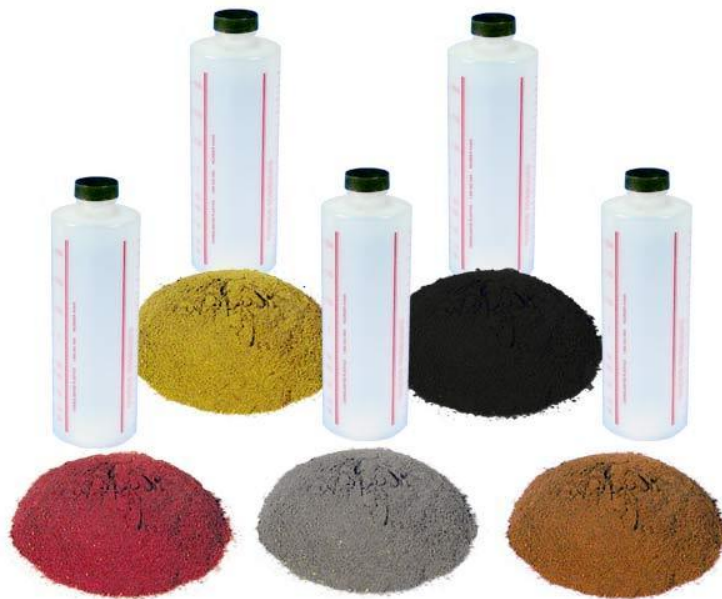
Slika 22: Čestice za suho magnetsko ispitivanje
