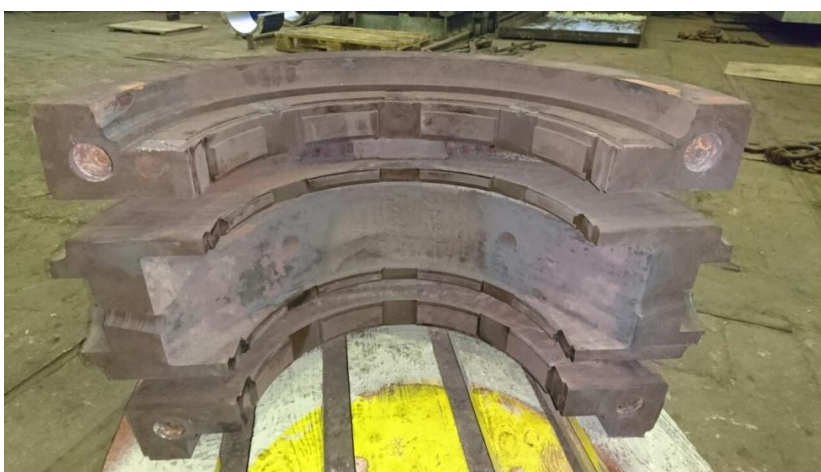
Slika 62: Čelični odljevak nakon žarenja
