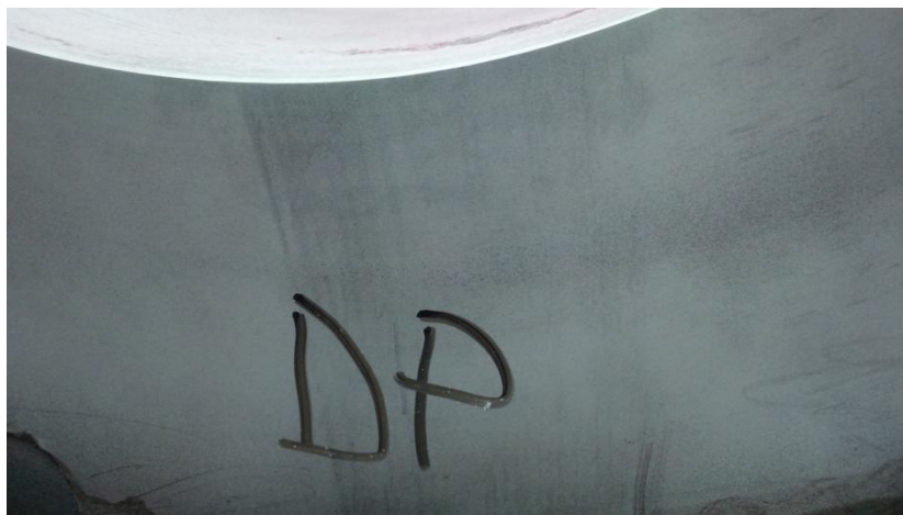
Slika 79: Dobar lijev kovine na donjoj polovici
