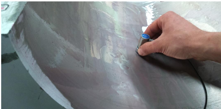
Slika 74: UZ ispitivanje donje polovice ležaja
