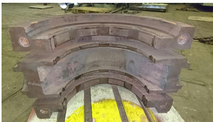
Slika 62: Čelični odljevak nakon žarenja
