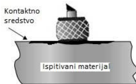
Slika 39: Kontaktno sredstvo kod ispitivanja kontaktnim sondama
