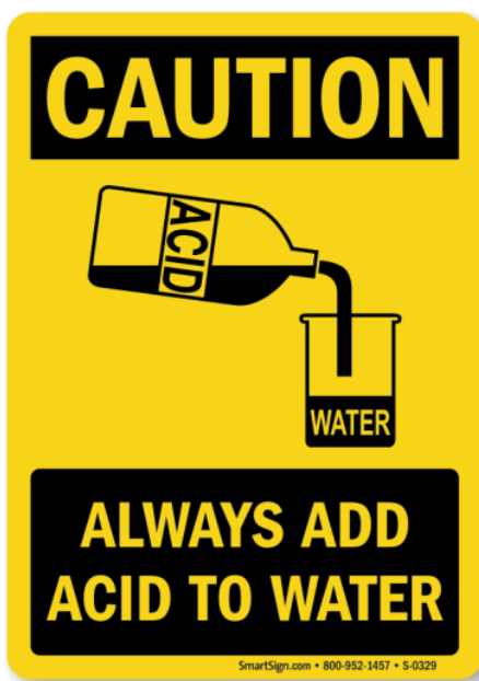
Slika 18. Način miješanja kiseline s vodom [27]
