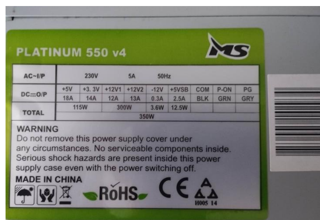
Slika 14. Predodžba tehničkih podataka PC napajanja. Izvor [Autor].
