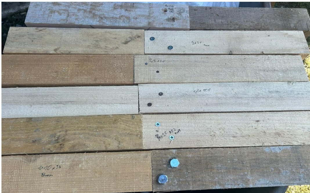
Slika 17. Uzorci za vlačno ispitivanje
