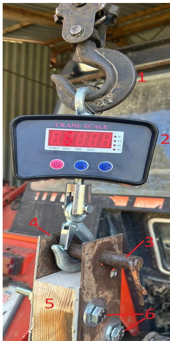
Slika 18. Spoj uzorka na ispitni sustav
