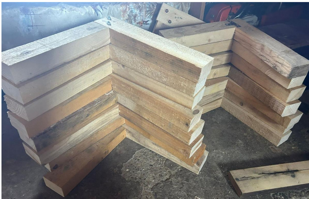
Slika 33. Uzorci za torzijsko ispitivanje
