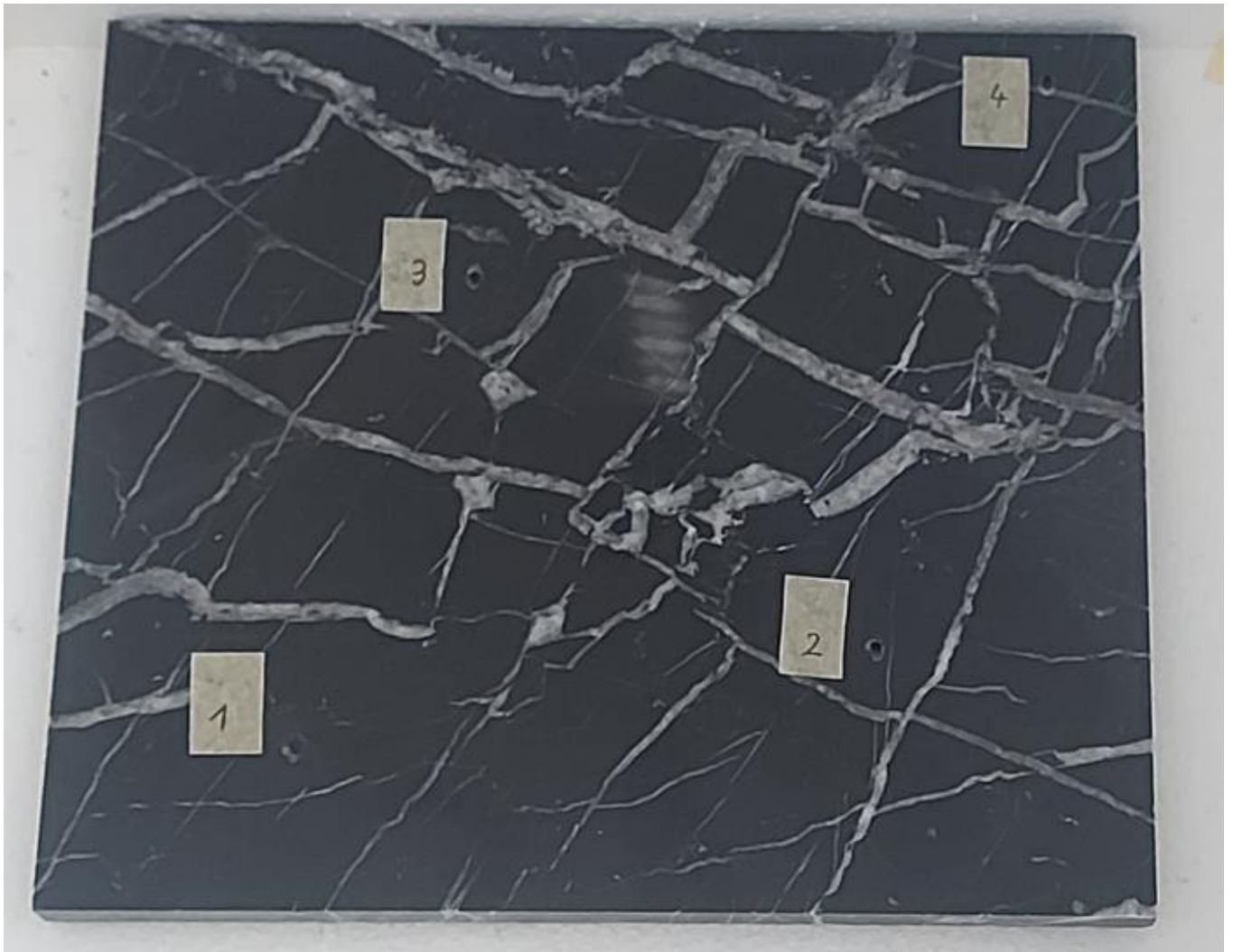
Slika 14 Prikaz ispitnog mramora i točaka mjerenja
