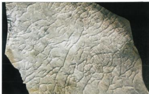
Slika 12. Fragment stakla bez oštih rubova, iznimno oštećen toplinom [25]
