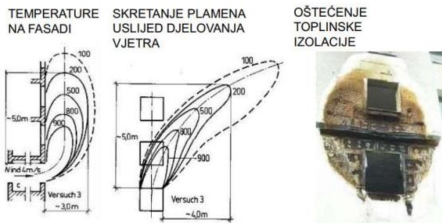
Slika 9: Prikaz izbijanja požara kroz vanjske prozore
