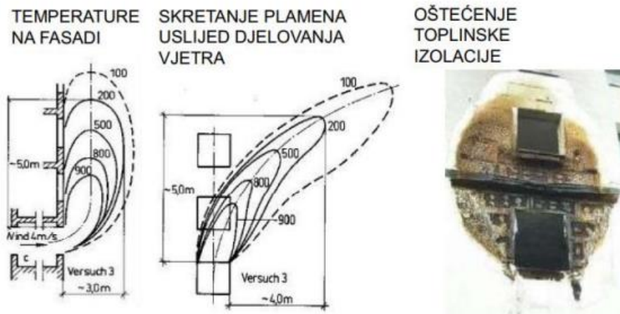
Slika 9: Prikaz izbijanja požara kroz vanjske prozore
