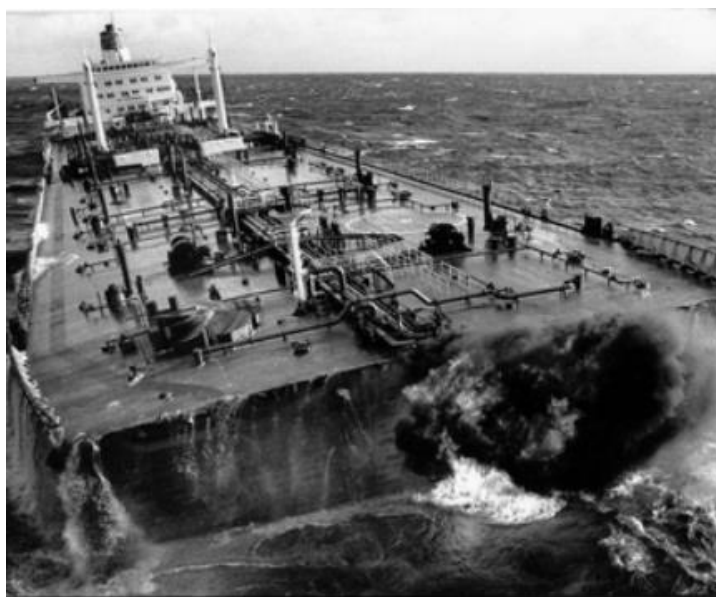
Slika 44. MV Kirki nakon što mu se pramac odlomio. [30]
