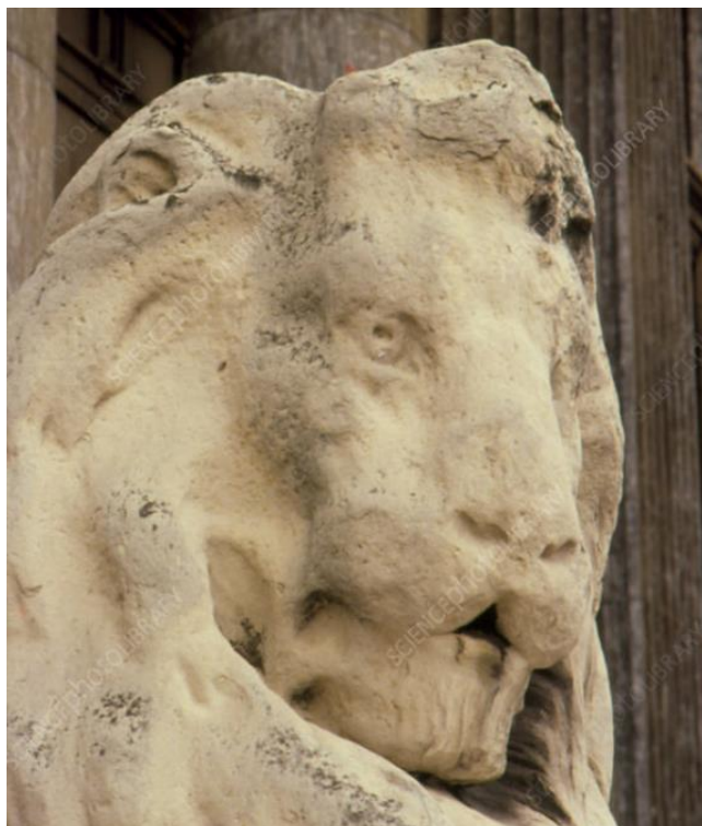
Slika 1. Kameni kip erodiran utjecajem kisele kiše. [2]
