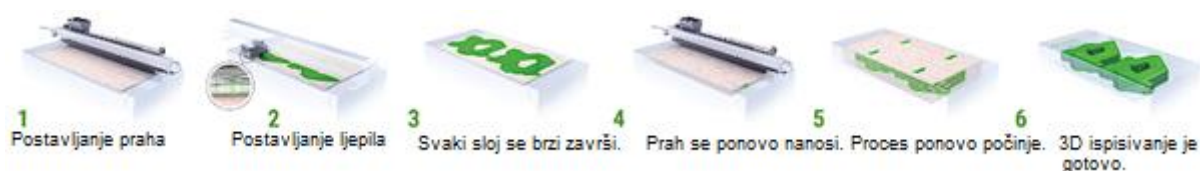
Slika 17 Proces tehnologije 3D tiskanja [14]
