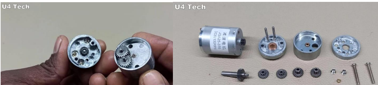
Slika 25. Predodžba dijelova unutar motora s reduktorom
