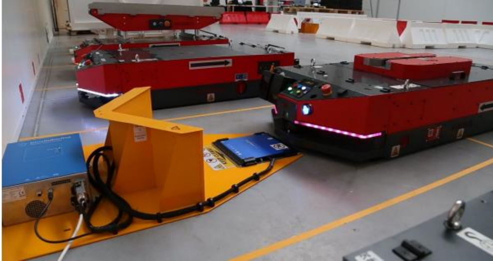
Slika 17. Predodžba stanice za beskontaktno punjenje AGV-a
