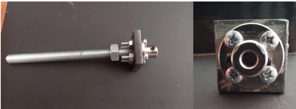
Slika 34. Predodžba vratila kotača
