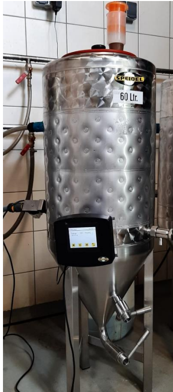
Slika 7. Speidel cilindrično-konusni fermentor (izvor: vlastita fotografija)
