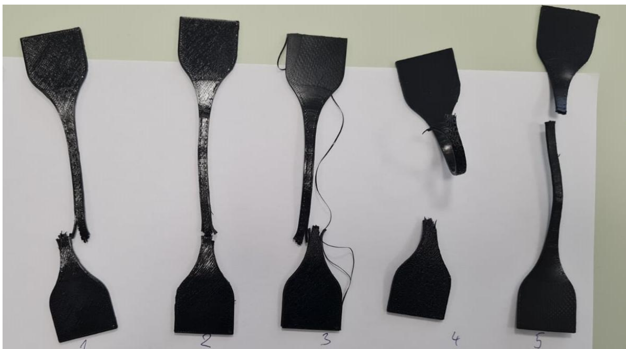
Slika 34. Epruvete od TPU 82A nakon provedenog ispitivanja
