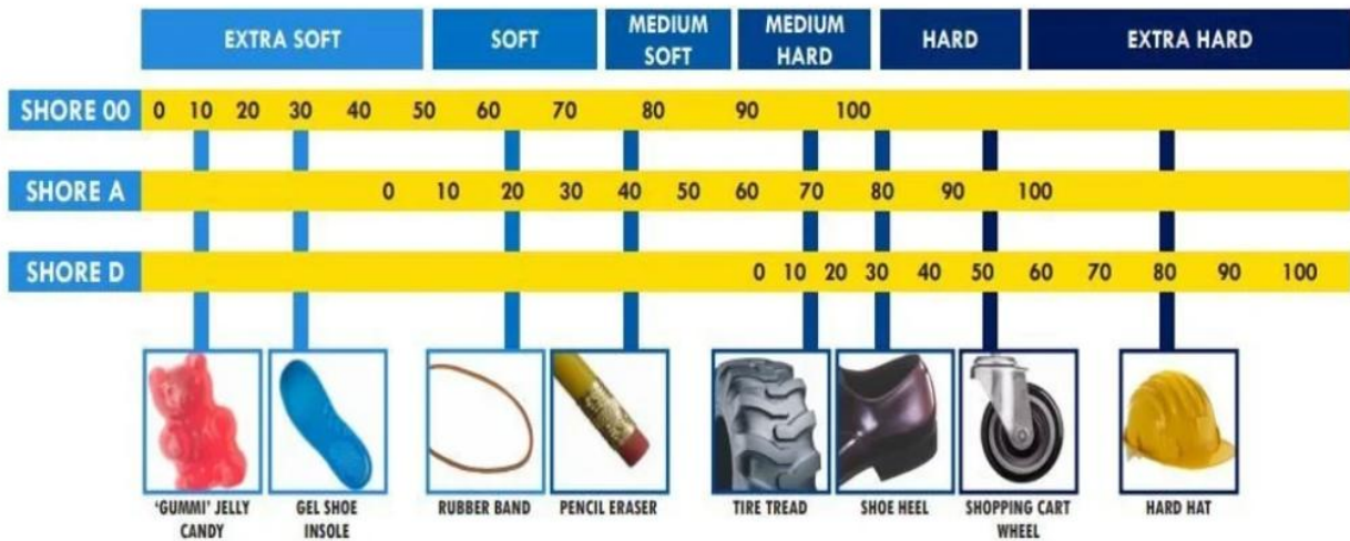
Slika 16. Podjela gume prema tvrdoći [6]
