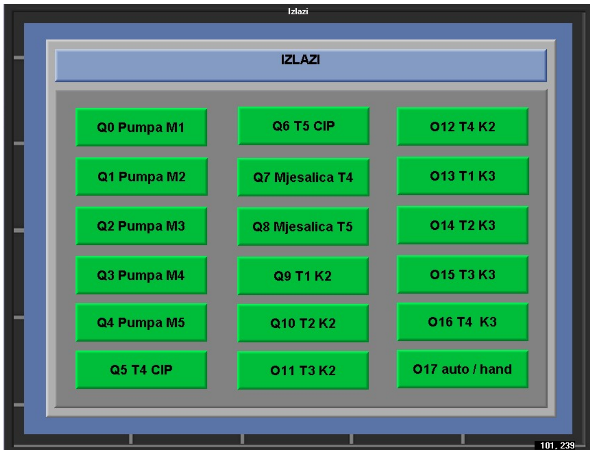
Slika 48. Predodžba aktivnih izlaza na PLC-u ili proširenju. Izvorno autor.
