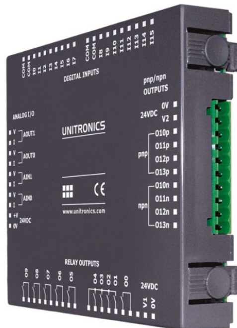
Slika 3. Predodžba ulaza i izlaza koji su na PLC-u
