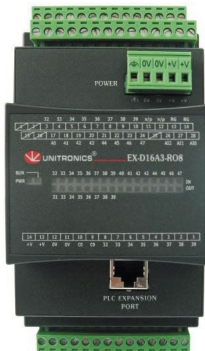
Slika 4. Predodžba proširenja digitalnih ulaza i izlaza
