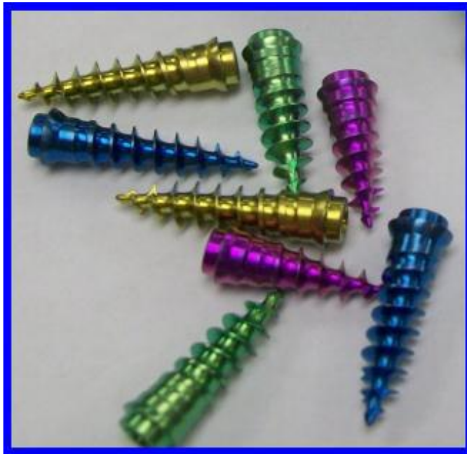
Slika 23. Uzorci nakon anodizacije [3]
