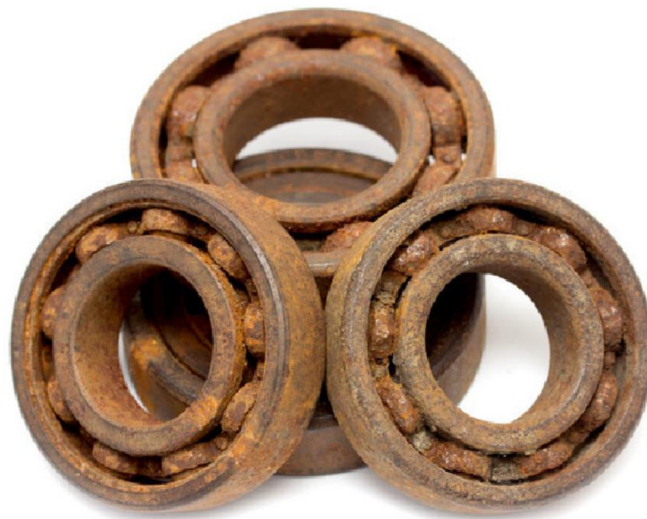
Slika 25. Primjer korodiranih ležajeva [10]
