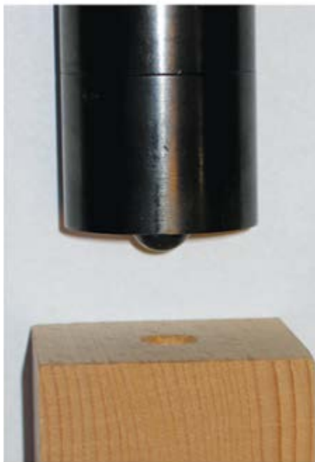
Slika 10. Postupak ispitivanja tvrdoće metodom Janka. [26]
