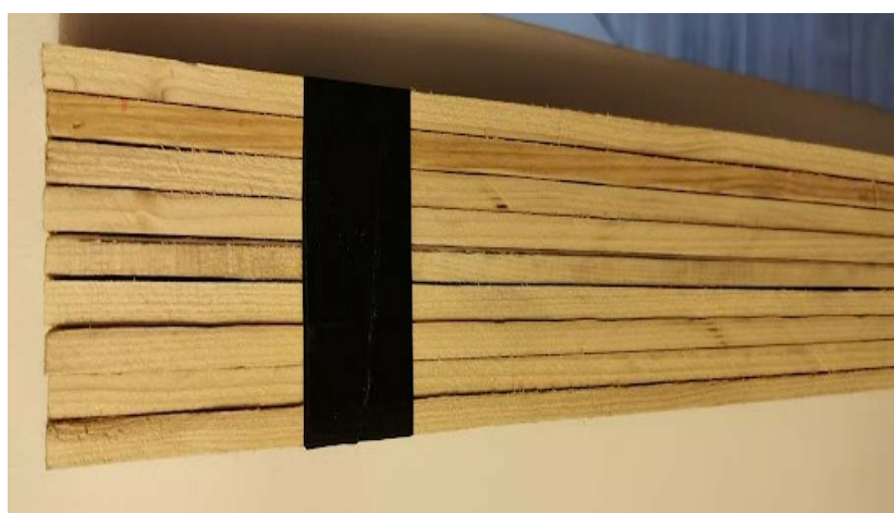
Slika 46. Izrezani uzorci dimenzija 1500x50x10 mm.
