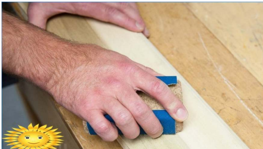
Slika 32. Priprema drvene površine brušenjem. [68]
