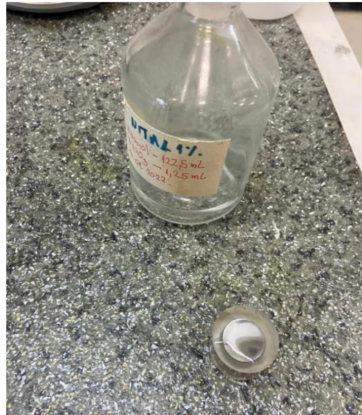
Slika 40. Nagrivanje uzorka Nitalom [18]
