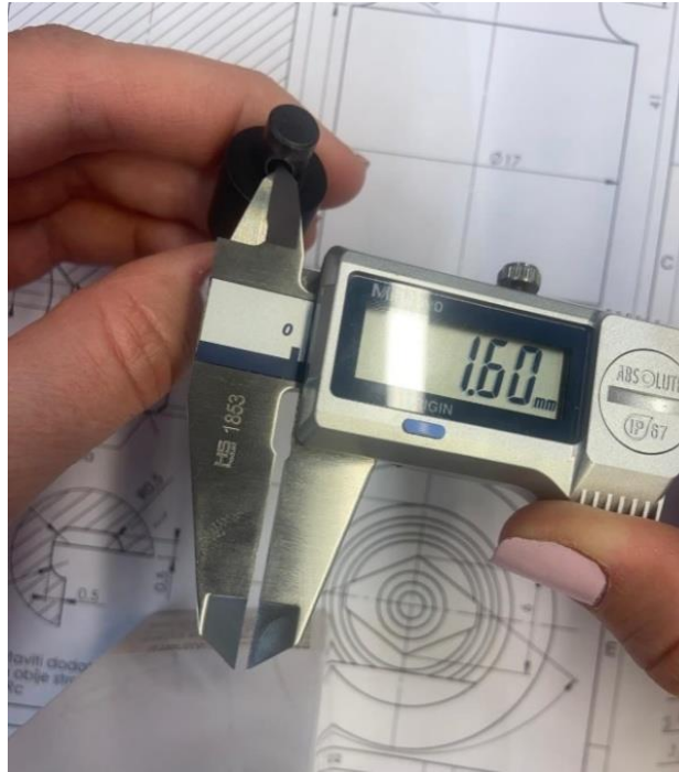
Slika 58. Mjerenje unutarnjeg promjera pomičnim mjerilom [18]
