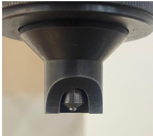
Slika 27. Penetrant u obliku kuglice – Brinell metoda [18]
