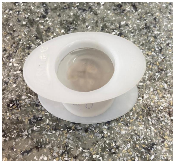
Slika 34. Uzorak zaliven smolom [18]
