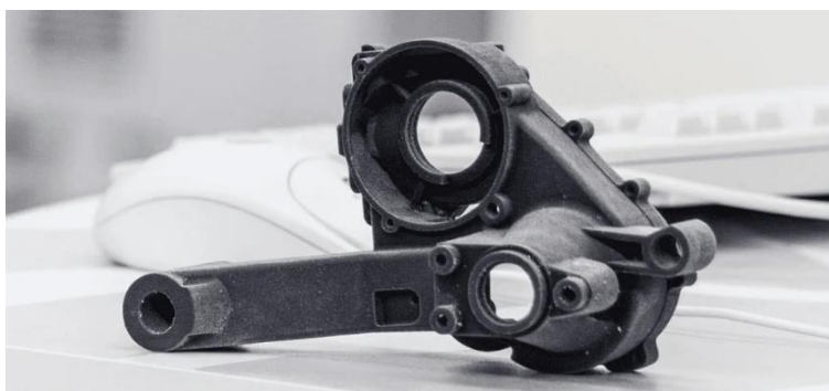
Slika 7. Dio isprintan Polyjet tehnologijom [6]
