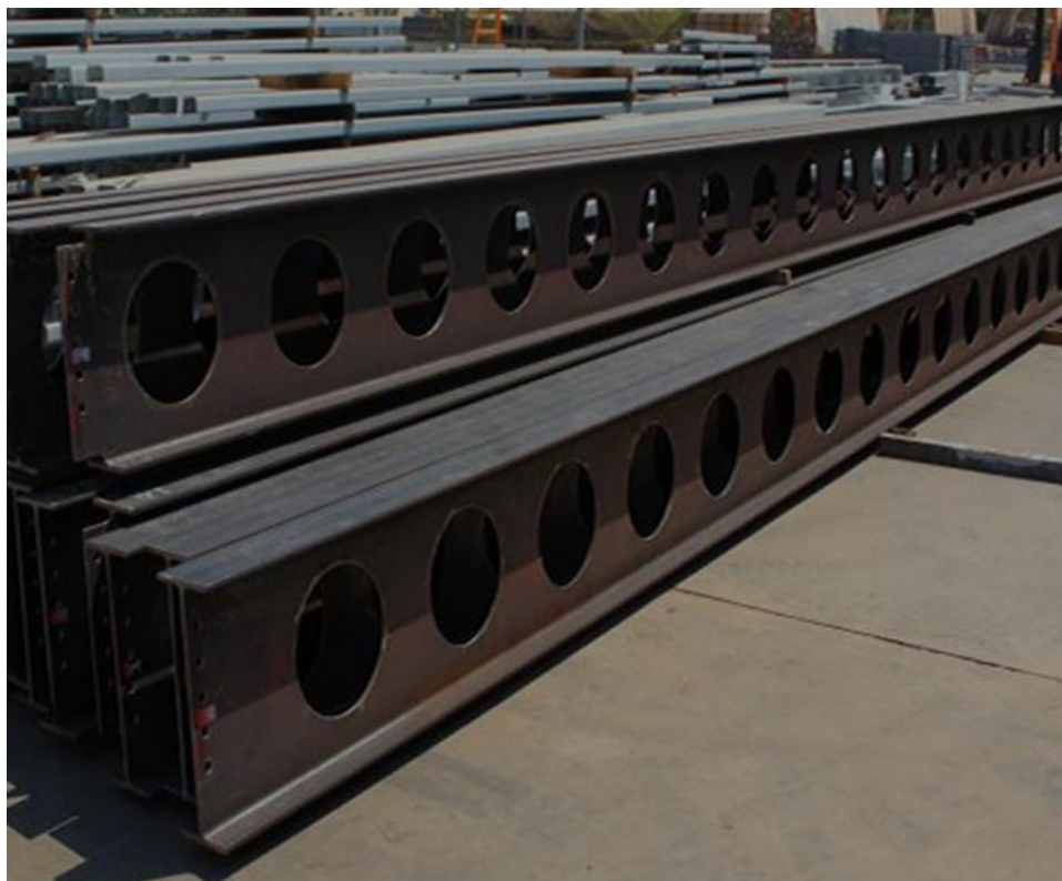
Slika 3. Specijalni I profil izrađen tehnologijom zavarivanja [4]
