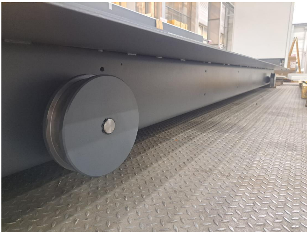
Slika 31. Pogonski kotači s vijencem na podvozju kolica
