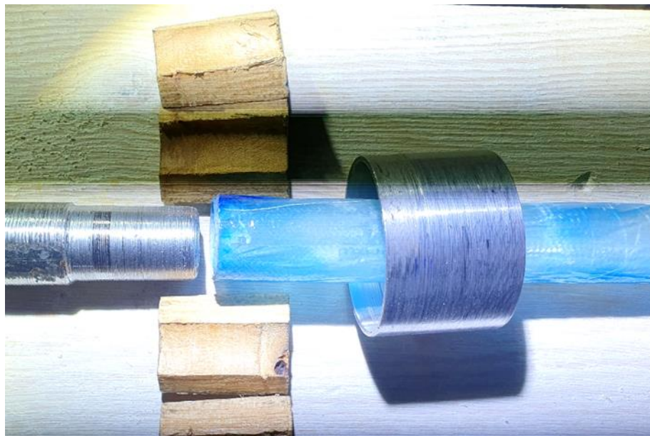
Slika 43. Uzorak +45^{\circ}/-45^{\circ} prije sklapanja spoja
