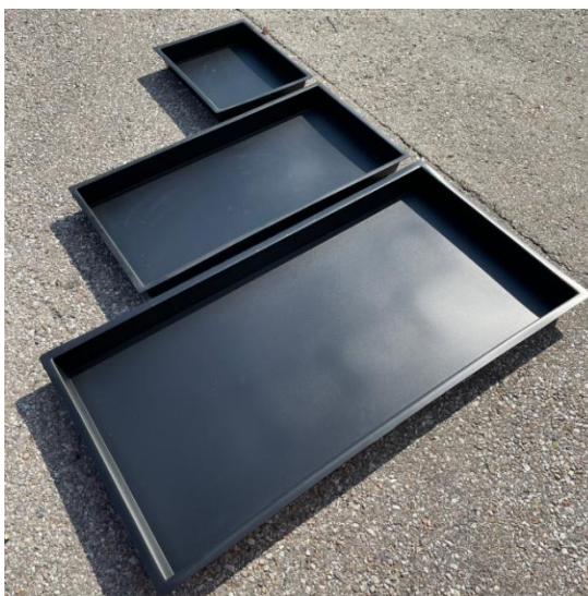
Slika 22. Jednodijelni kalupi za izradu kompozita [17]
