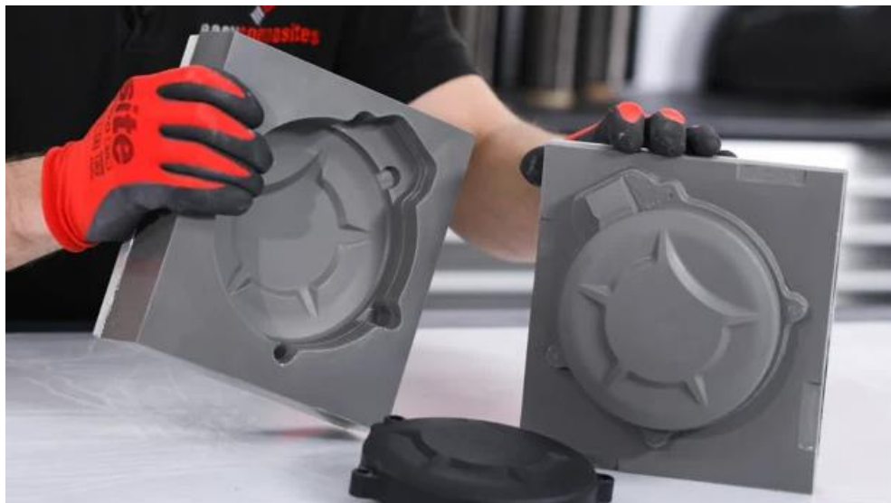
Slika 23. Dvodijelni kalup za izradu kompozita [18]
