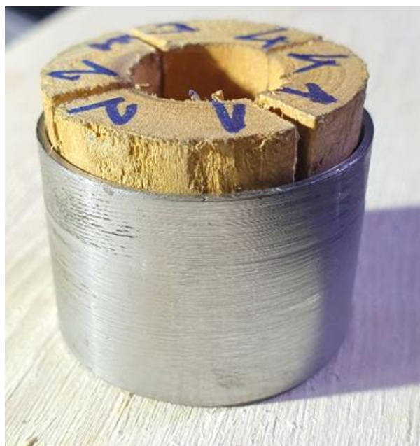
Slika 42. Stezna konusna čahura
