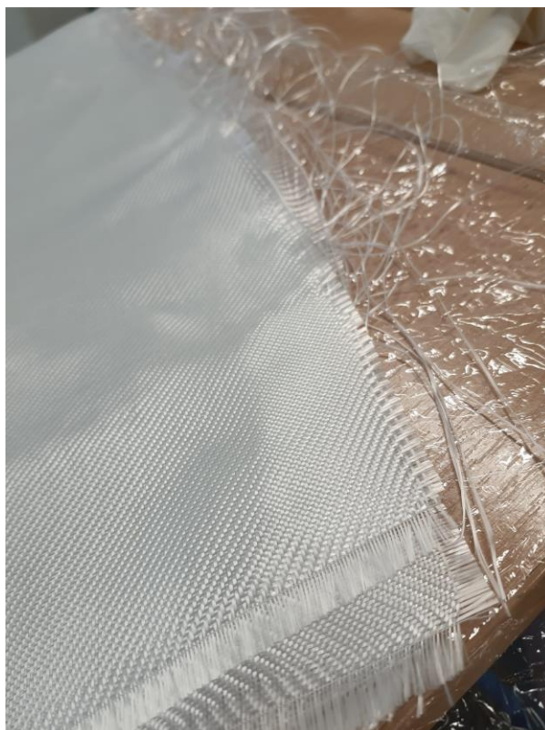
Slika 32. Staklena vlakna orijentirana pod pravim kutom
