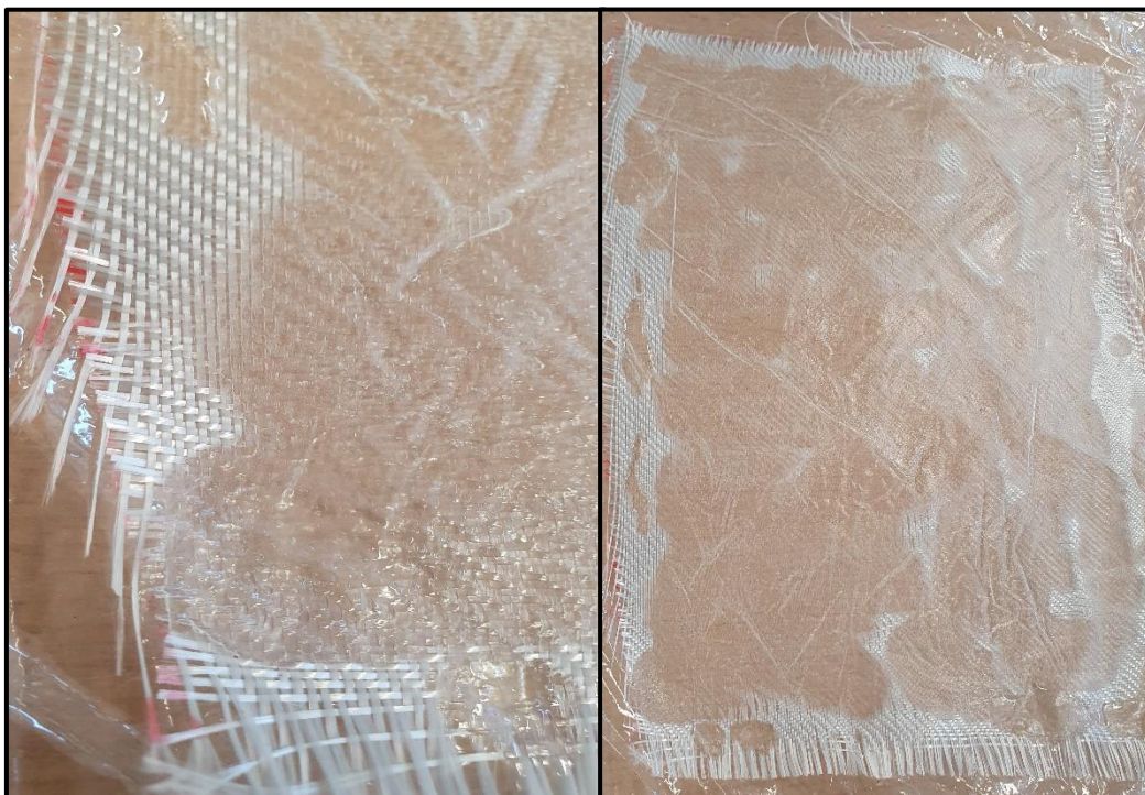
Slika 36. Tkanina namočena epoksidnom smolom
