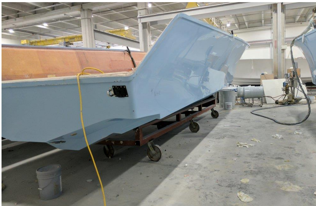
Slika 2. Dio trupa broda izrađen od kompozita [2]
