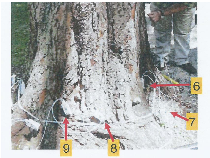
Slika br. 24 Mjerenje metodom impulsne tomografije (Dijagnostička dokumentacija elaborata za Šetalište dr. Franje Tuđmana, Stablosan d.o.o., 2012.)
