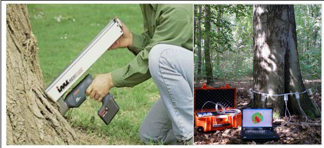
Slika br.17 Mjerenje rezistografom i tomografom ( http://www.zestecintegrated.com/contents/en-us/d2.html )
