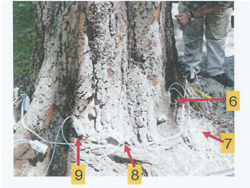
Slika br. 24 Mjerenje metodom impulse tomografije (Dijagnostička dokumentacija elaborata za Šetalište dr. Franje Tuđmana, Stablosan d.o.o., 2012.)
