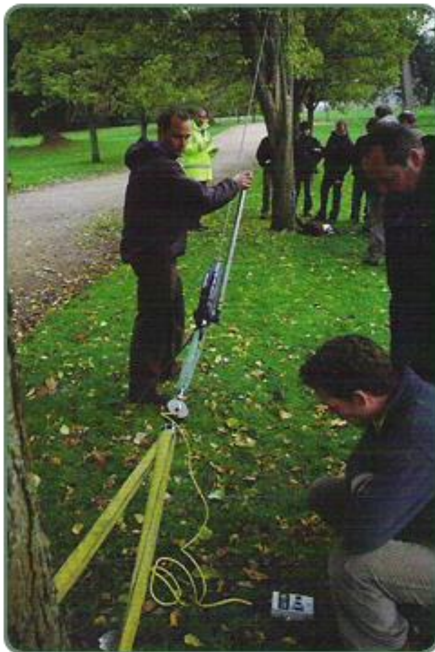
Slika br.19 Izvođenje poteznog testa
