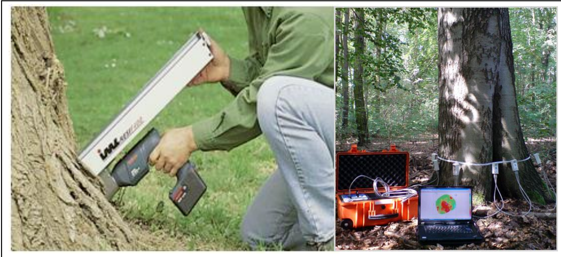
Slika br.17 Mjerenje rezistografom i tomografom ( http://www.zestecintegrated.com/contents/en-us/d2.html )
