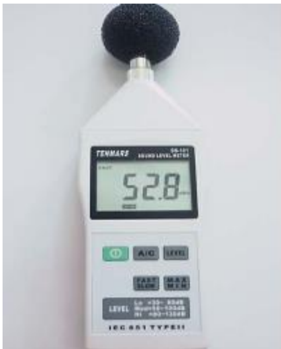
Slika 4. Primjer uređaja za mjerenje zvuka. [29]
