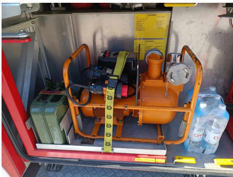
Slika 23. Pumpa za pretakanje opasnih tvari [6]
