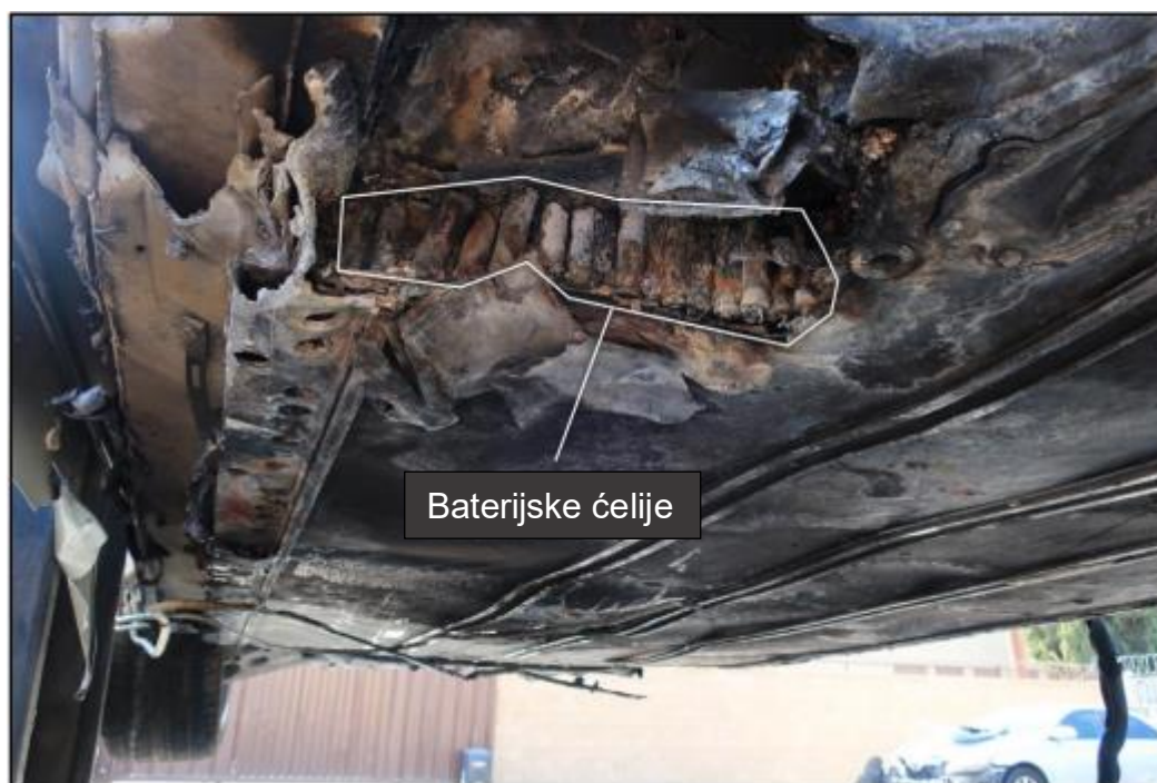
Slika 23. Oštećeno kućište visokonaponske baterije [10]
