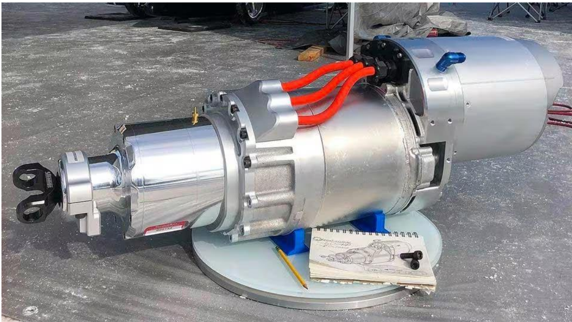
Slika 2. Elektromotor za vozilo. [4]
