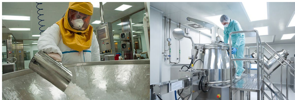
Slika 55. Odijelo za zaštitu od čvrstih/krutih čestica kemijskih tvari u zraku (tip 5) te za rad u sterilnim uvjetima farmaceutske industrije pri rukovanju praškastim supstancama.
