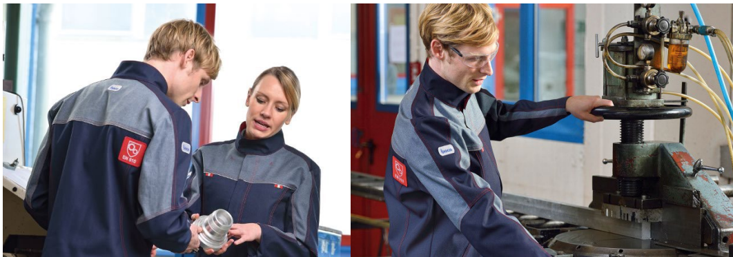
Slika 13. Zaštitna odjeća za rad na strojevima sa rotirajućim dijelovima. Jasno se vidi otisnuti piktogram EN 510.
