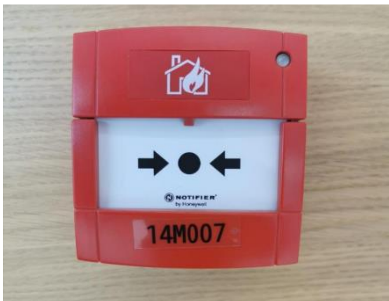
Slika 17. Ručni javljač sa vidljivom adresom [8]
