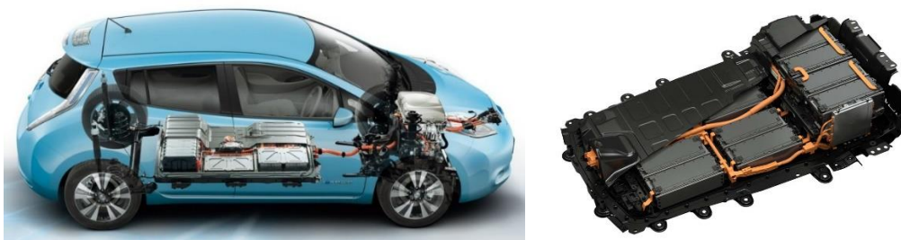
Slika 16. Baterija električnog vozila [12]
