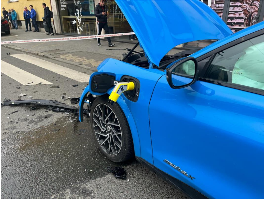
Slika 45. Pravilna upotreba Emergency Plug utikača [7]
