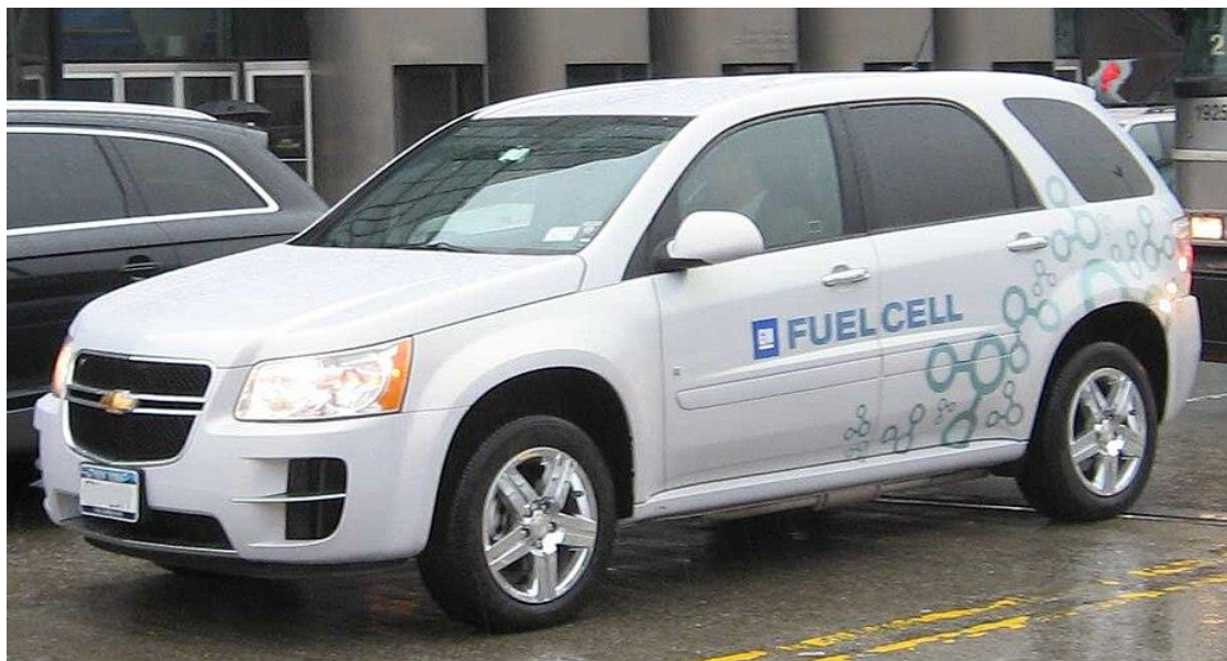
Slika 12. Chevrolet Equinox hibrid s vodikovim gorivim člankom [2]
