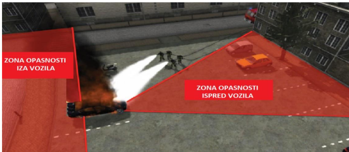
Slika 49. Akcija gašenja električnog ili hibridnog vozila [8]
