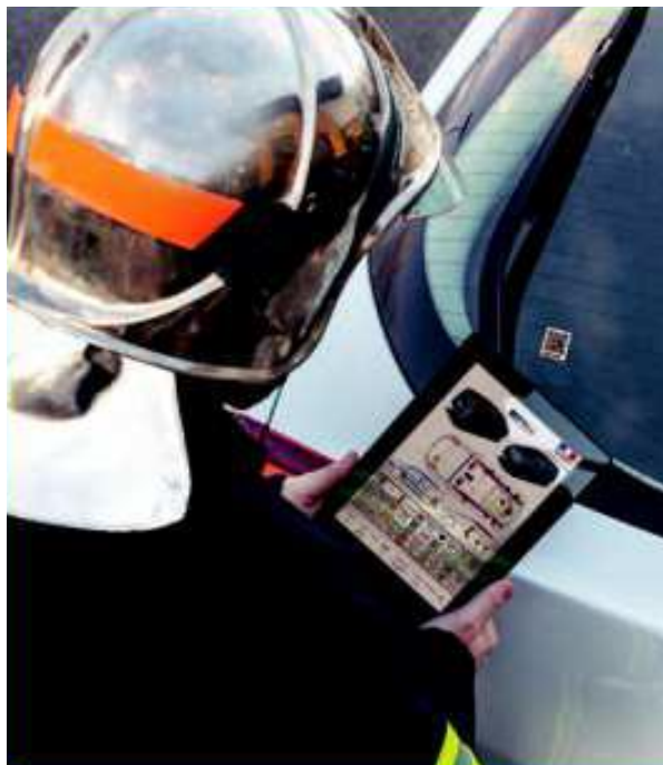
Slika 43. Identifikacija vozila pomoću bar koda na staklu
