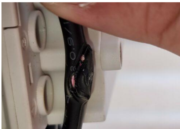
Slika 17. Prikleštene istosmjernog vodiča poklopcem kućišta [7]
