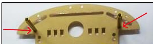
Slika 19: Postavljanje bakrenih stupova
