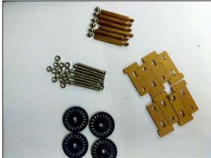
Slika 13: Vijci, bakreni stupovi, pločice za fiksiranje motora
