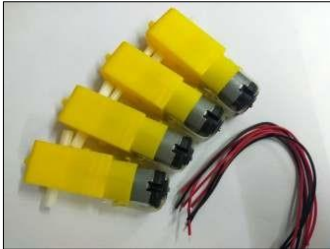
Slika 11: Istosmjerni motori i žice za povezivanje
