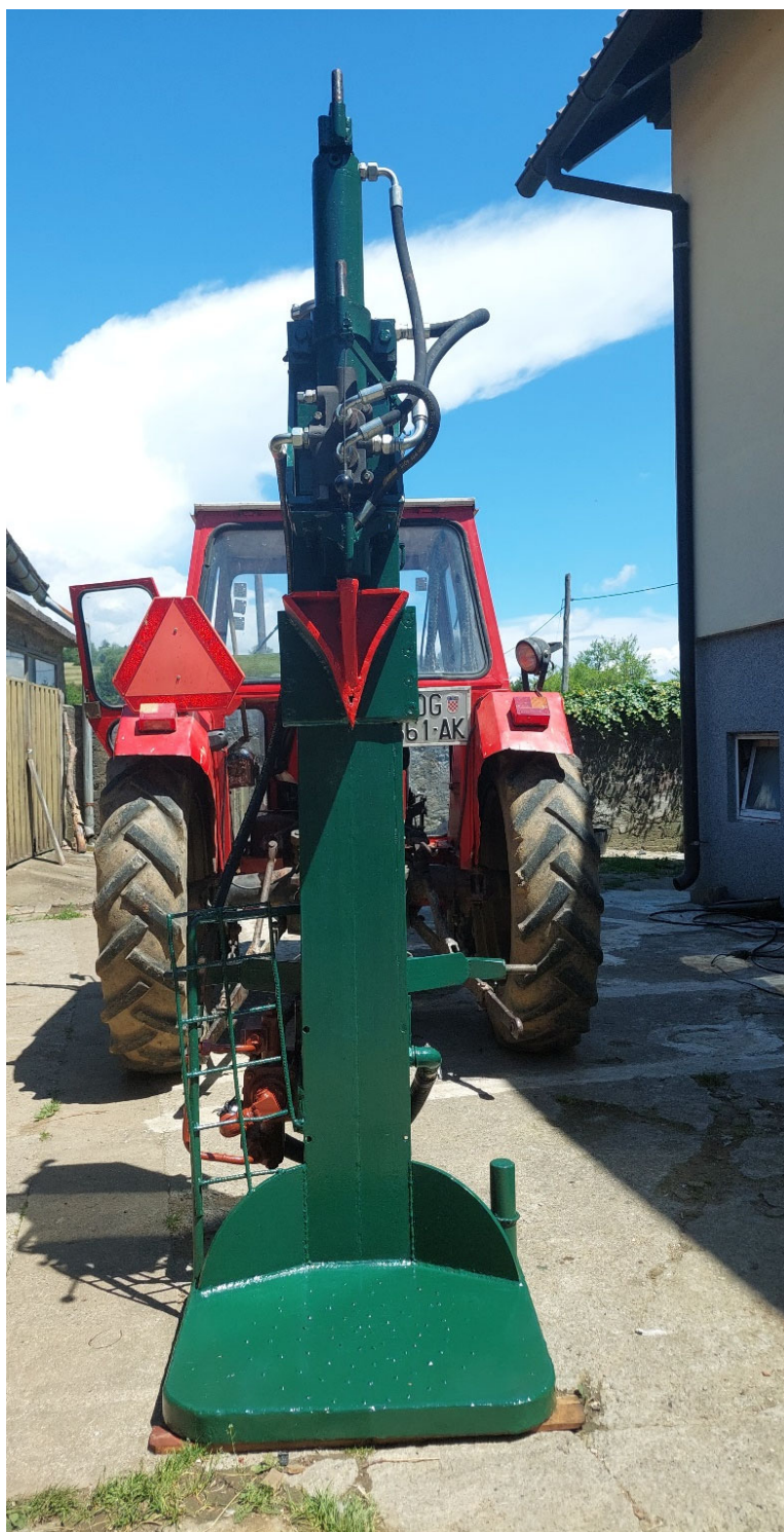
Slika 47. Izrađeni cjepač za drva
