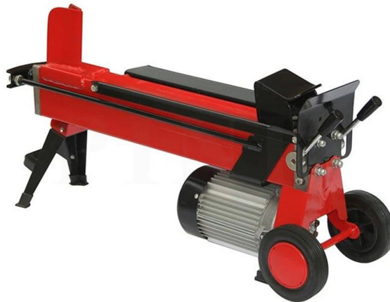
Slika 5. Horizontalni cjepač za drva [13]
