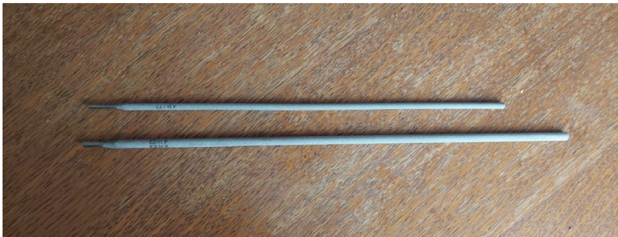
Slika 41. Elektroda za zavarivanje 2,5 mm (gore) i 3,25 mm (dolje)
