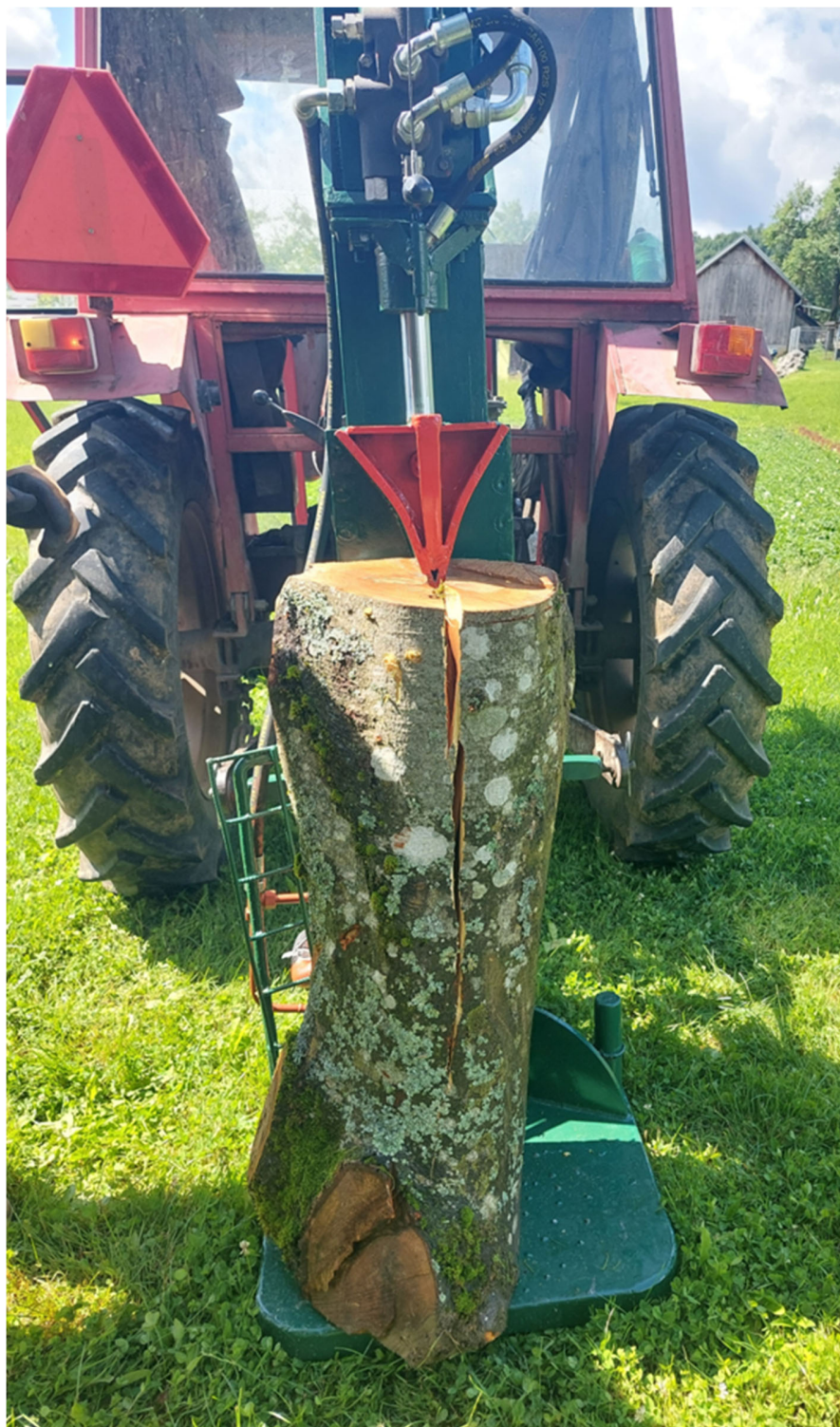
Slika 48. Izrađeni cjepač usred cijepanja
